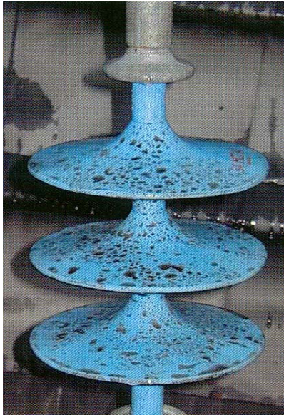
Σχήμα 2. 5: Μονωτήρας που αποικήθηκε από μύκητες στο εργαστήριο.
