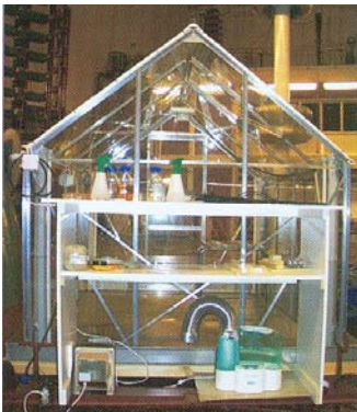
Σχήμα 2. 4: Ειδικός θάλαμος προσομοίωσης κλιματικών συνθηκών.
