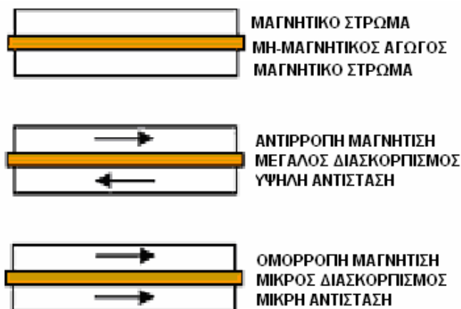
Εικόνα 3.7: Αρχή λειτουργίας μαγνητοαντιστάσεων (GMR)
