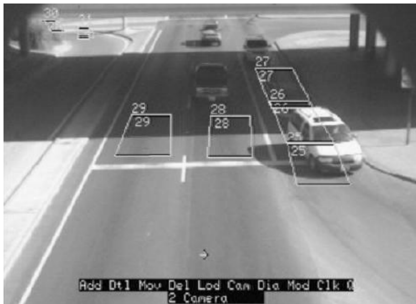
Εικόνα 2.22: Σκίαση λόγω αερογέφυρας
