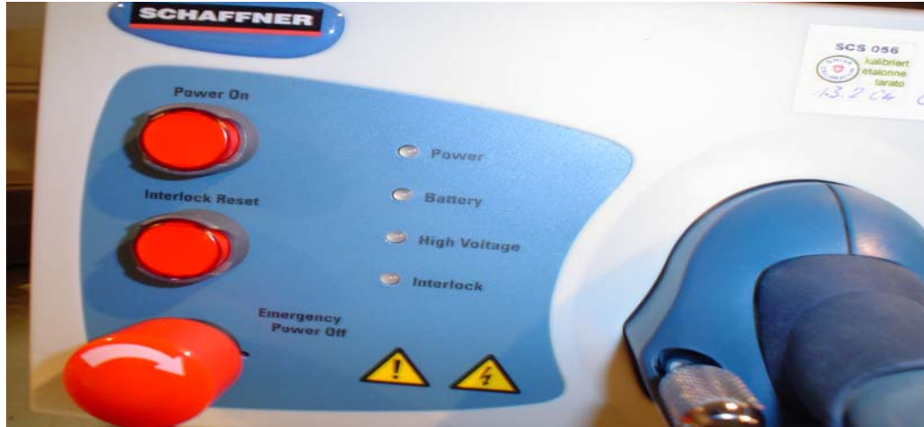
Σχήμα 4.6: Η βασική μονάδα της γεννήτριας με τα μπουτόν και τις ενδεικτικές λυχνίες
