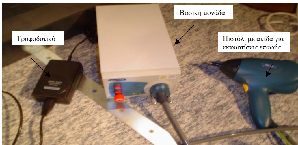
Σχήμα 4.5: Τα βασικά τμήματα της γεννήτριας NSG-438 και η μεταξύ τους συνδεσμολογία
