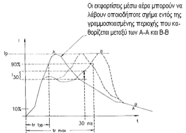
Σχήμα 2.3: Κυματομορφές ρεύματος για εκφορτίσεις σε διαφορετικές τάσεις σύμφωνα με το πρότυπο ANSI.
