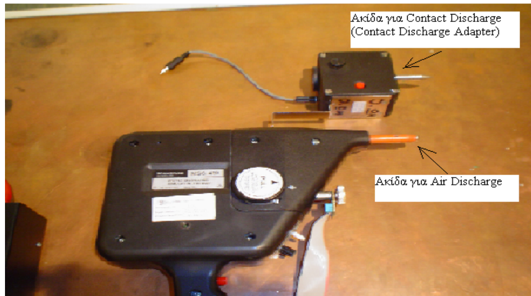
Σχήμα 4.4: Ακίδες για εκκενώσεις μέσω αέρα και επαφής για την γεννήτρια NSG-433
