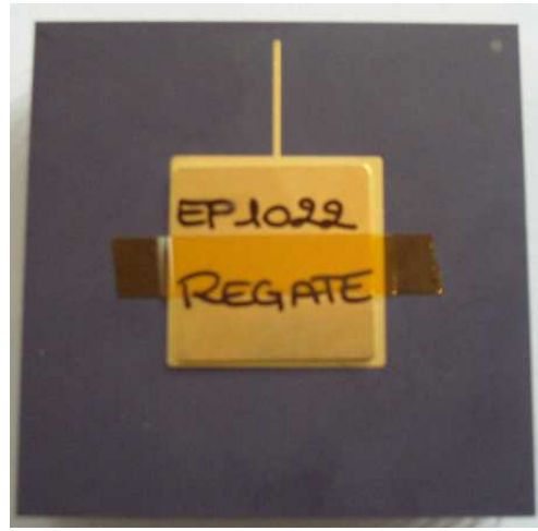
Σχήμα 1.5: Πάνω όψη του REGATE SoC
