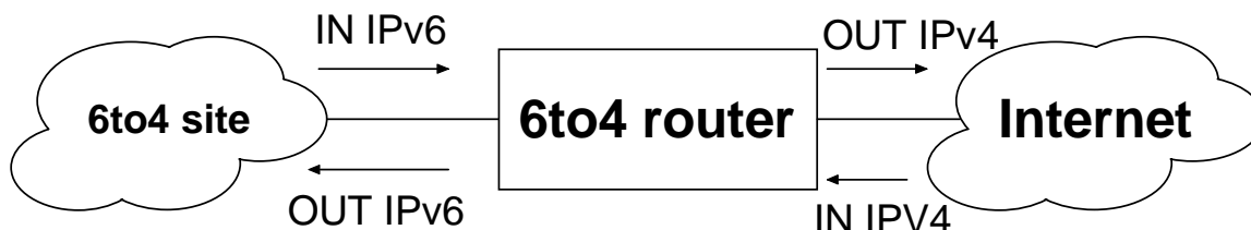
Σχήμα 27: Κίνηση από και προς τον 6to4 router.
