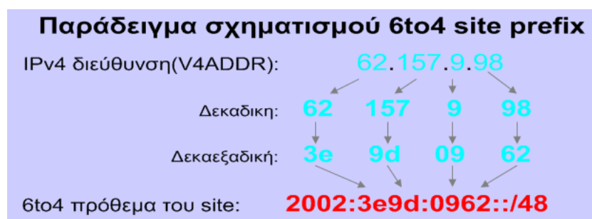
Σχήμα 16: Σχηματισμός του 6to4 site prefix
