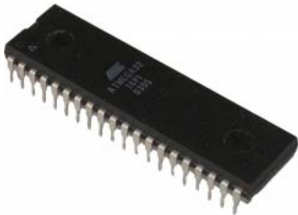
Εικόνα 2.14 : Ο ATmega32 της ATMEL σε DIP-40 πακετάρισμα
