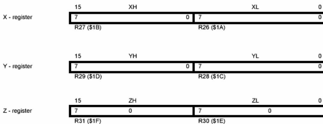
Εικόνα 2.18 : Οι διπλοί καταχωρητές X-, Y-, Z- του AVR
