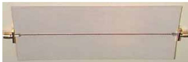
Σχήμα 3.4: Διάταξη PBG που δημιουργήθηκε με τη διάνοιξη οπών στο διηλεκτρικό.
