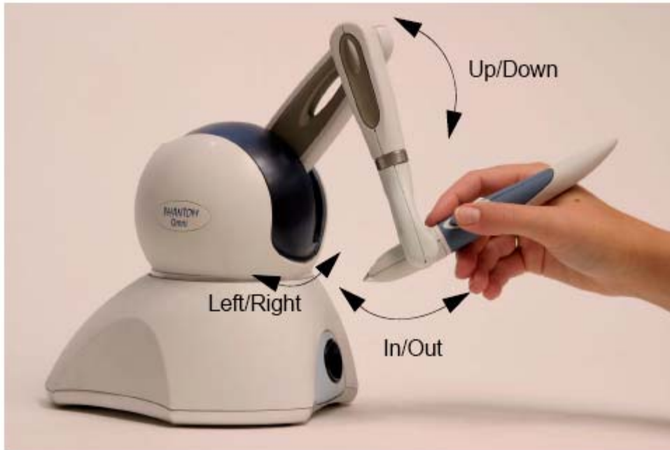
α) κινήσεις του βραχίονα της διάταξης (ενεργοί βαθμοί ελευθερίας)
