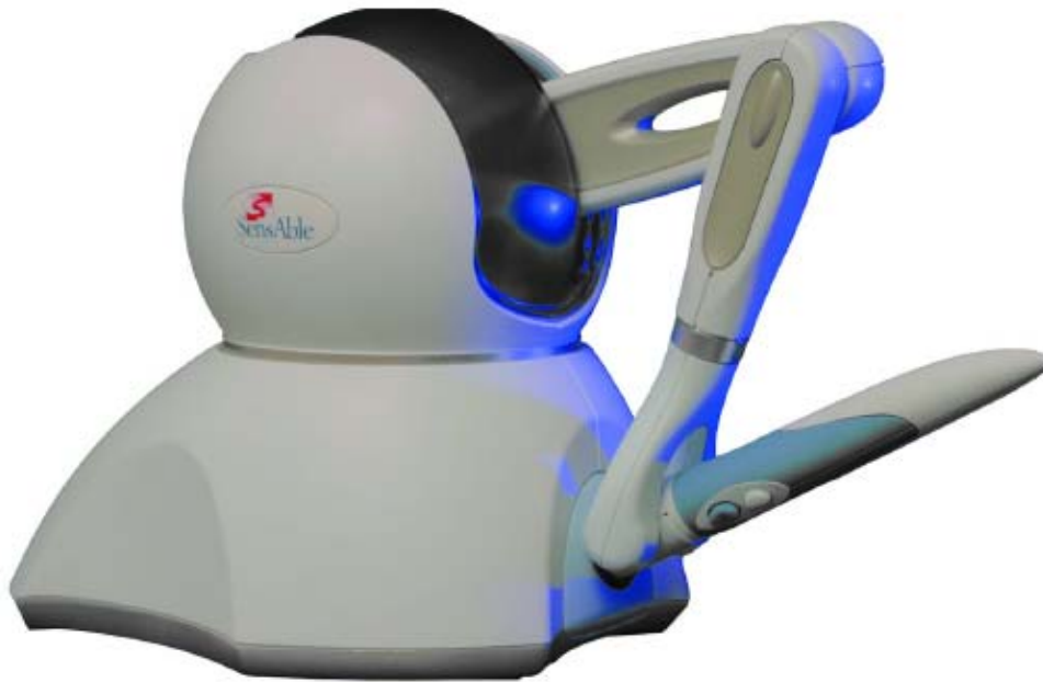
Σχήμα 3.2 Απτική διάταξη : Phantom Omni
