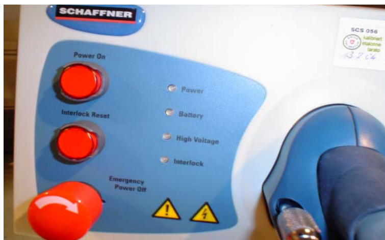
Εικόνα 4.6: Η βασική μονάδα της γεννήτριας με τα κομβία και τις ενδεικτικές λυχνίες
