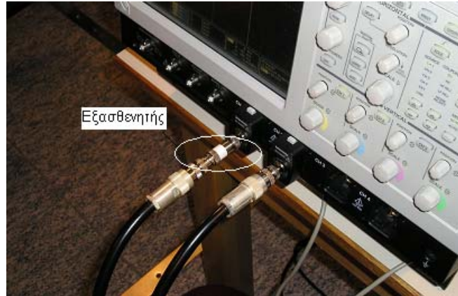
Εικόνα 4.16: Κανάλι ρεύματος, με εξασθενητή – Κανάλι πεδίου, χωρίς εξασθενητή
