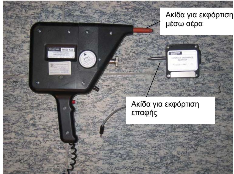
Εικόνα 4.4: Ακίδες για εκκενώσεις μέσω αέρα και επαφής για τη γεννήτρια NSG-433
