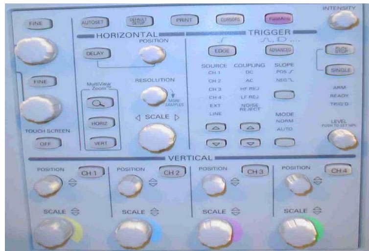
Εικόνα 4.12: Κομβία χειρισμού του παλμογράφου Tektronix TDS 7254B
