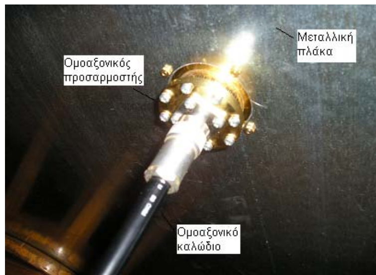
Εικόνα 4.9: Ο ομοαξονικός προσαρμοστής τοποθετημένος στη διάταξη
