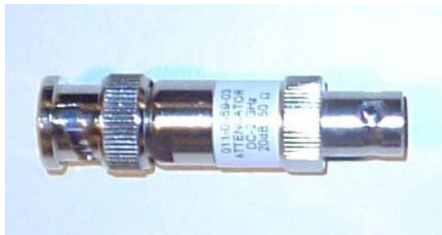
Εικόνα 4.10: Ο εξασθενητής (attenuator) 011-0059-03
