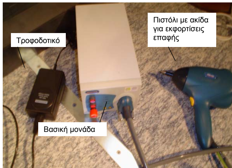
Εικόνα 4.5: Τα βασικά τμήματα της γεννήτριας NSG-438 και η μεταξύ τους συνδεσμολογία
