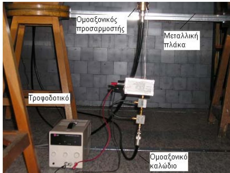
Εικόνα 4.15: Αισθητήρας και κύκλωμα οδήγησής του, μετά τη σύνδεση στη διάταξη
