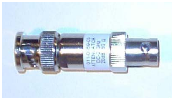
Εικόνα 4.10: Ο εξασθενητής (attenuator) 011-0059-03
