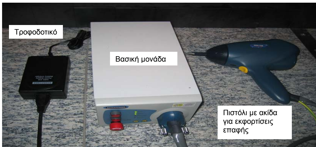
Εικόνα 4.5: Τα βασικά τμήματα της γεννήτριας NSG-438 και η μεταξύ τους συνδεσμολογία
