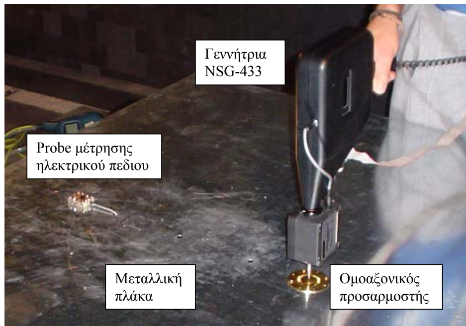
Εικόνα 4.17: Η πειραματική διάταξη κατά τη διάρκεια εκφόρτισης
