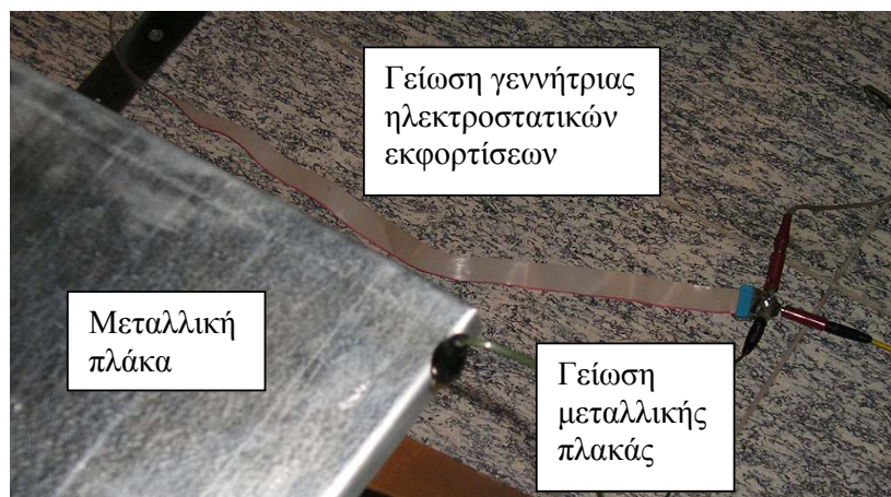
Εικόνα 4.2: Η γείωση της μεταλλικής πλάκας
