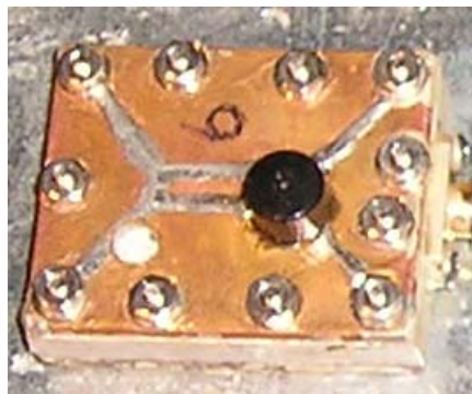
Εικόνα 4.13: Το probe για τη μέτρηση της έντασης E του ηλεκτρικού πεδίου
