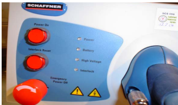
Εικόνα 4.6: Η βασική μονάδα της γεννήτριας με τα μπουτόν και τις ενδεικτικές λυχνίες
