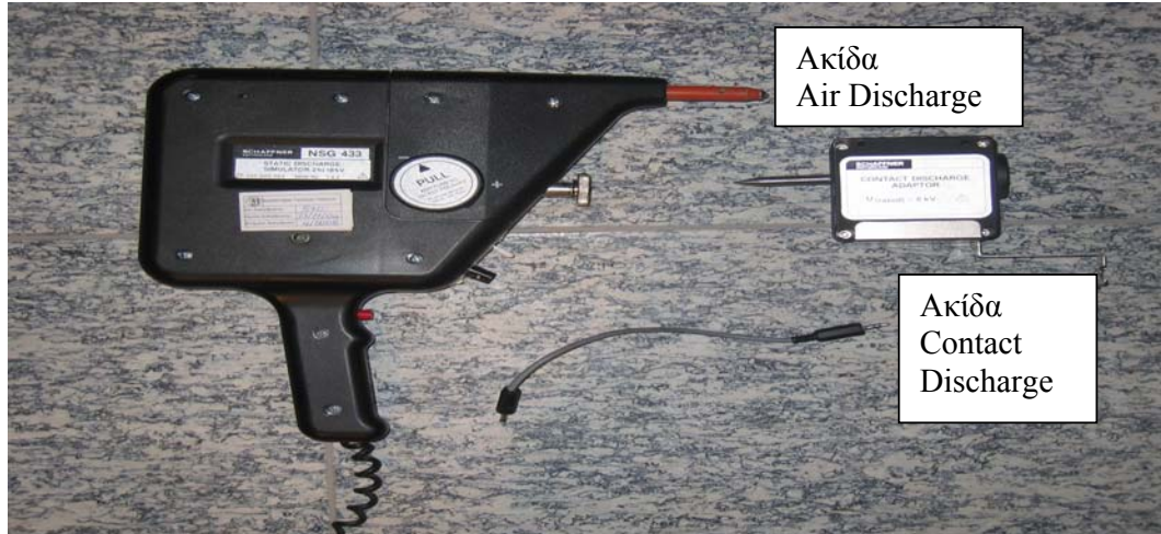
Εικόνα 4.4: Ακίδες για εκκενώσεις μέσω αέρα και επαφής για τη γεννήτρια NSG-433
