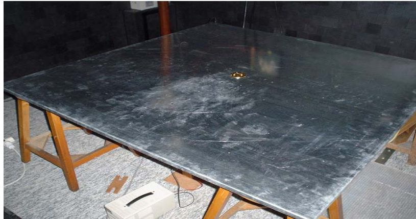
Εικόνα 4.1: Η πειραματική διάταξη στο εσωτερικό του ανηχωτικού θαλάμου
