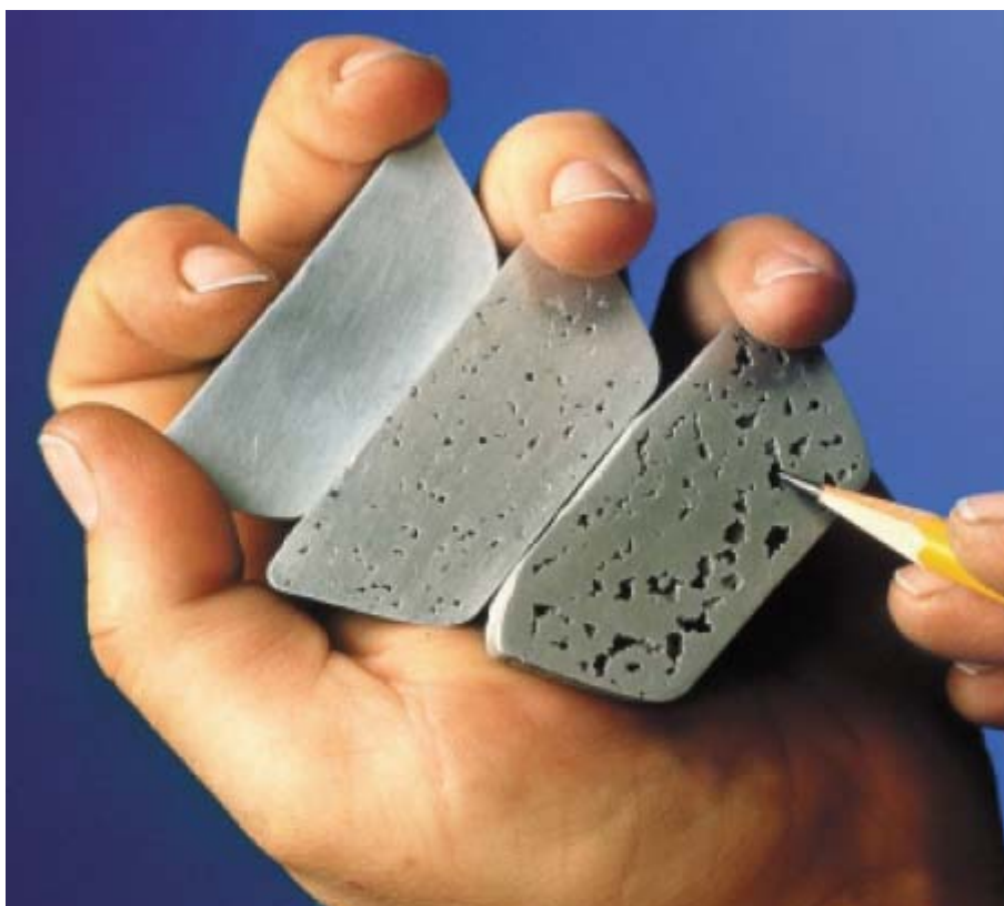
Σχήμα 2.3-9: Τομές χυτού αλουμινίου με ή χωρίς επεξεργασία SF 6 .
