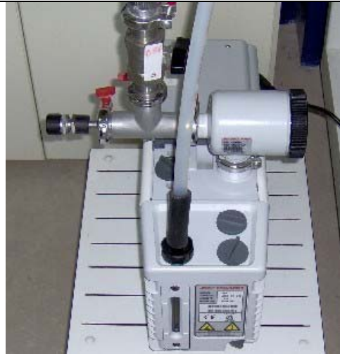
Διαβάθμιση περιστροφικής αντλίας κενού για τον έλεγχο της οπίσθιας πίεσεως (Backing Pressure).
