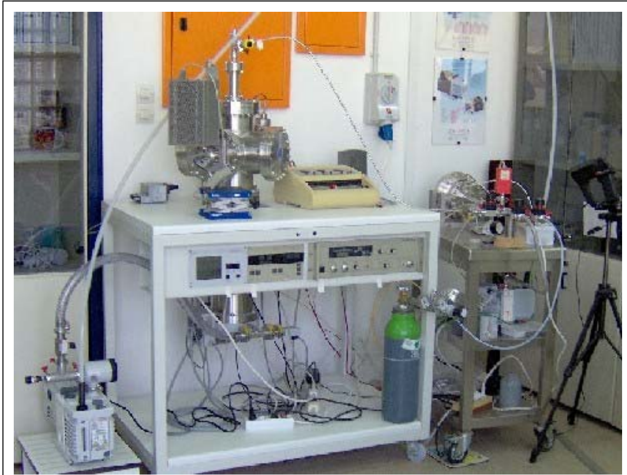
Γενική άποψη του τετραπολικού φασματογράφου μάζας στο εργαστήριο ηλεκτρομονωτικών υλικών.
