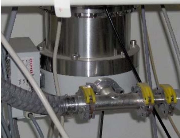
Αντλία δημιουργίας υψηλού κενού για την άντληση του κυρίως θαλάμου που εμπεριέχει τον φασματογράφο.
