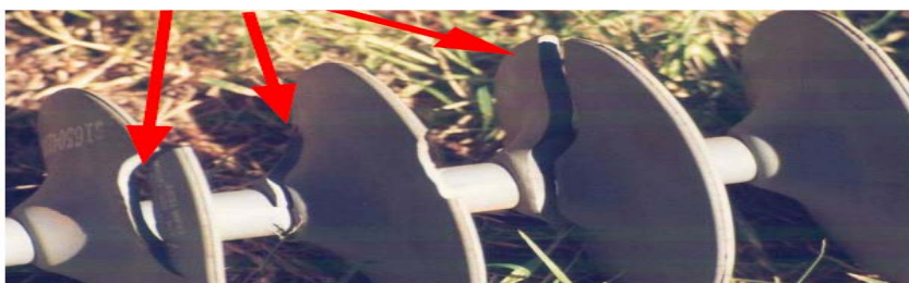
Σχήμα 3.17: Βλάβη στους δίσκους μονωτήρα με μείωση του μήκους ερπυσμού >10% από σπάσιμο
