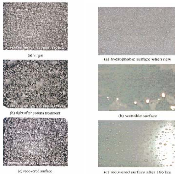
Σχήμα 3.23: (α) υδρόφοβη επιφάνεια πριν την έναρξη του φαινομένου corona, (β) αύξηση διαβρεξιμότητας μετά την εκδήλωση των εκκενώσεων corona (γ) ανάκτηση της υδροφοβικότητας
