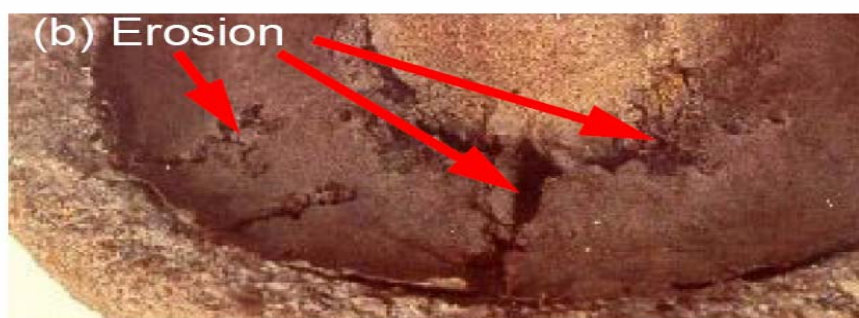
Σχήμα 3.11: Βλάβη στο πολυμερές περίβλημα εξαιτίας της διαβρώσεως
