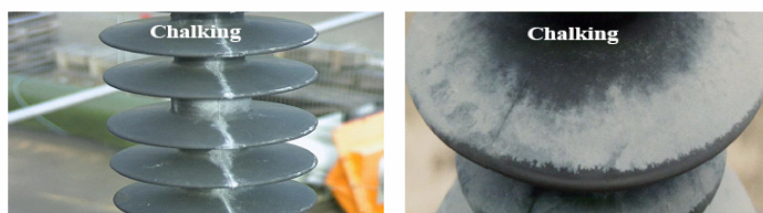
Σχήμα 3.1: Αλλοίωση στην περιοχή των δίσκων του μονωτήρα
