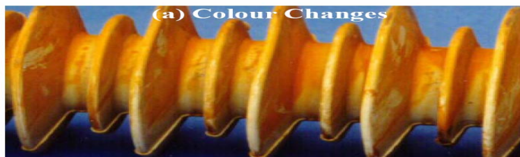
Σχήμα 3.2: Αλλοίωση στην περιοχή των δίσκων με μεταβολή του χρώματος που επικαλύπτει το μονωτήρα.
