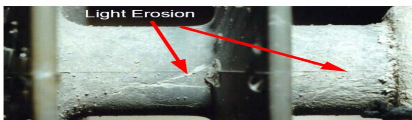
Σχήμα 3.6: Αλλοίωση στο περίβλημα / άτρακτο του μονωτήρα
