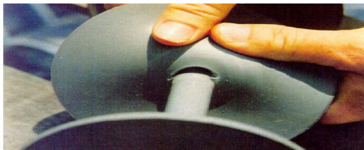
Σχήμα 3.7: Αλλοίωση στη διεπιφάνεια μεταξύ δίσκου και περιβλήματος του μονωτήρα
