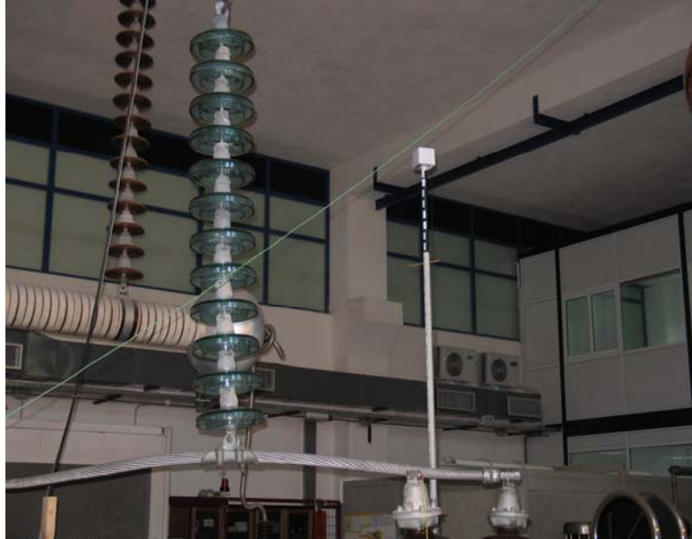
Σχήμα 4.61: Καθαρός γυάλινος αλυσοειδής μονωτήρας, τύπου ομίχλης, αποτελούμενος από δώδεκα (12) δισκοειδείς μονωτήρες
