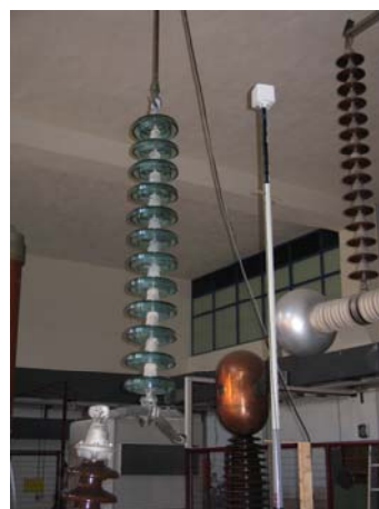
Σχήμα 3.11: Η θέση του πεδιομέτρου γύρω από το μονωτήρα και τον αγωγό Υ.Τ.
