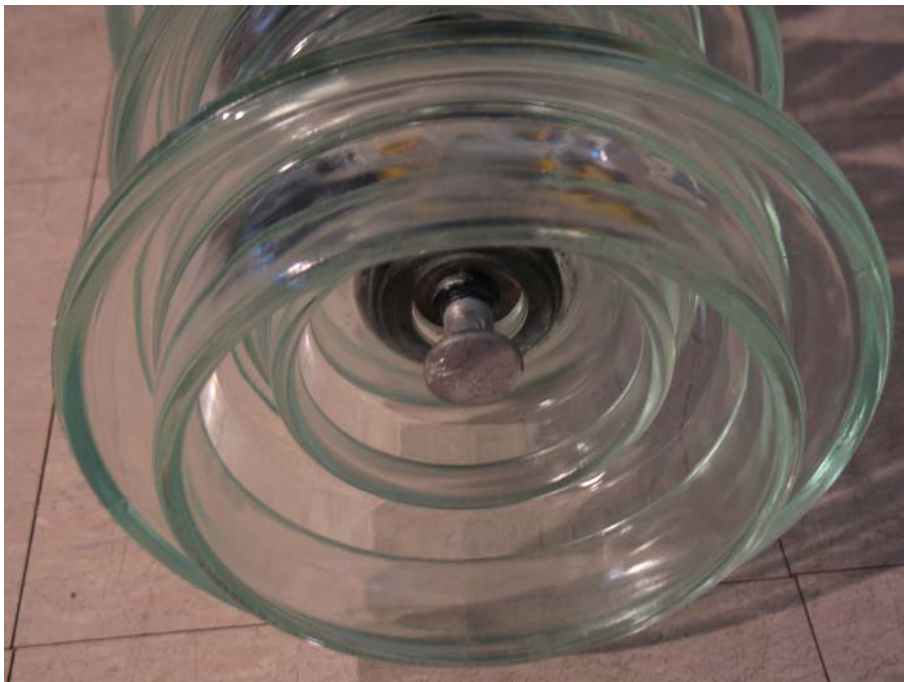
Σχήμα 3.3: Γυάλινος δισκοειδής μονωτήρας, τύπου ομίχλης
