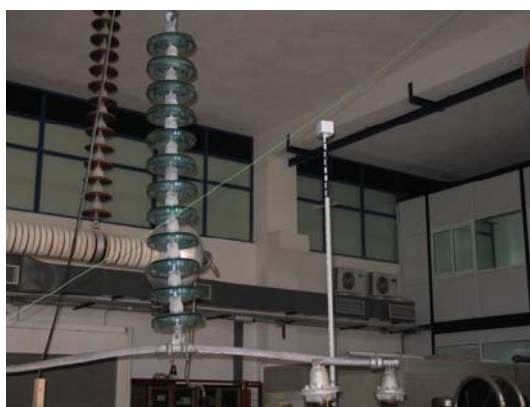
Σχήμα 3.11: Η θέση του πεδιομέτρου γύρω από το μονωτήρα και τον αγωγό Υ.Τ.
