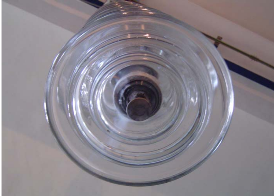
Σχήμα 3.2: Γυάλινος δισκοειδής μονωτήρας, τύπου κανονικού
