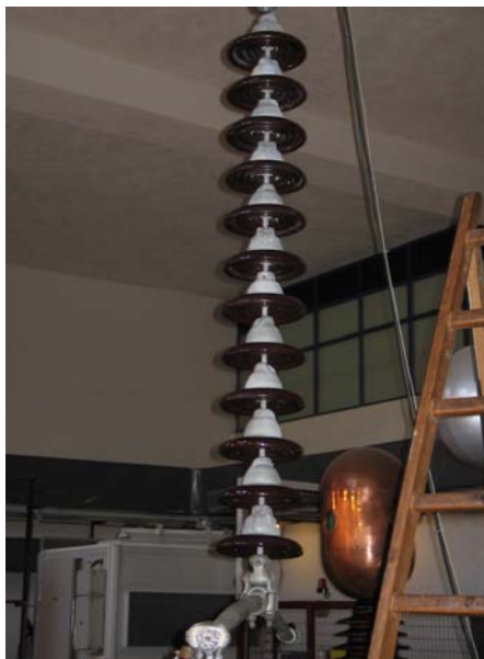
Σχήμα 4.1: Καθαρός πορσελάνινος αλυσοειδής μονωτήρας, τύπου κανονικού, αποτελούμενος από δώδεκα (12) δισκοειδείς μονωτήρες,
