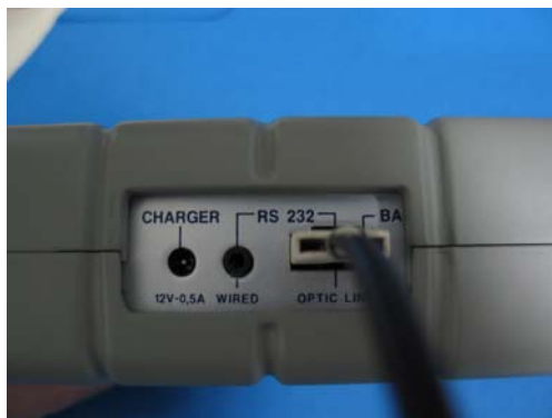
Σχήμα 3.14: Σύνδεση πεδιομέτρου με την οπτική ίνα
