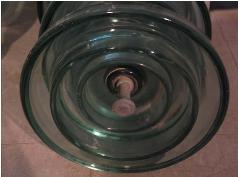
Σχήμα 3.4: Γυάλινος δισκοειδής μονωτήρας, τύπου ομίχλης
