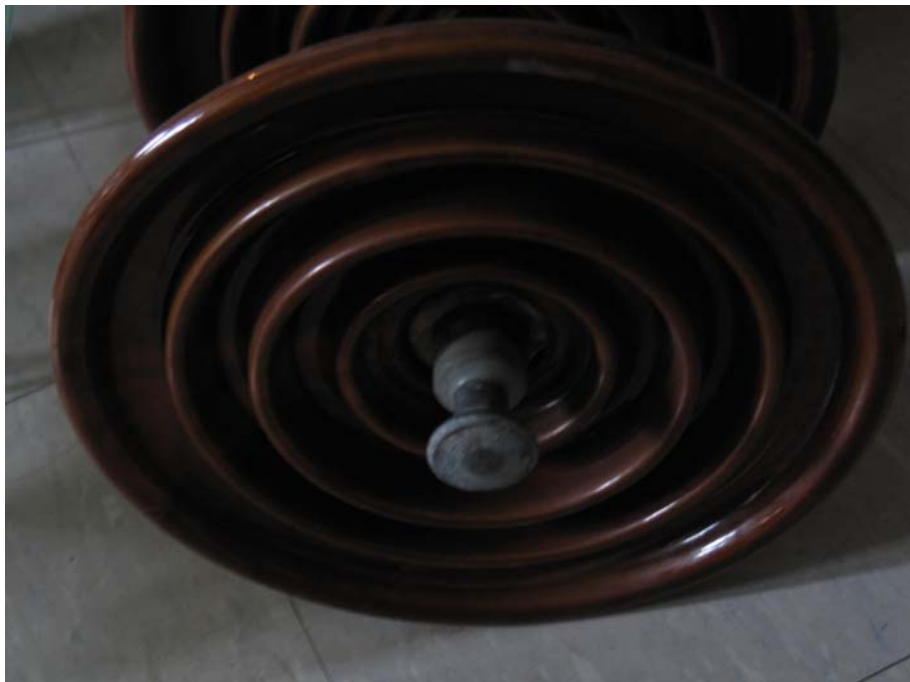
Σχήμα 3.5: Πορσελάνινος δισκοειδής μονωτήρας, τύπου κανονικού
