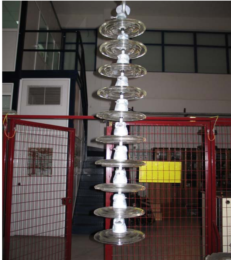
Σχήμα 4.25: Γυάλινος αλυσοειδής μονωτήρας, κανονικού τύπου, αποτελούμενος από δέκα (10) δισκοειδείς μονωτήρες
