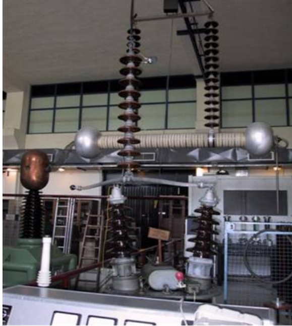
Σχήμα 4.73: Πορσελάνινος αλυσοειδής μονωτήρας, κανονικού τύπου, αποτελούμενος από δέκα (10) δισκοειδείς μονωτήρες
