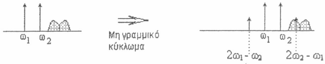
Σχήμα 4.11 Αλλοίωση λόγω ενδοδιαμόρφωσης.
