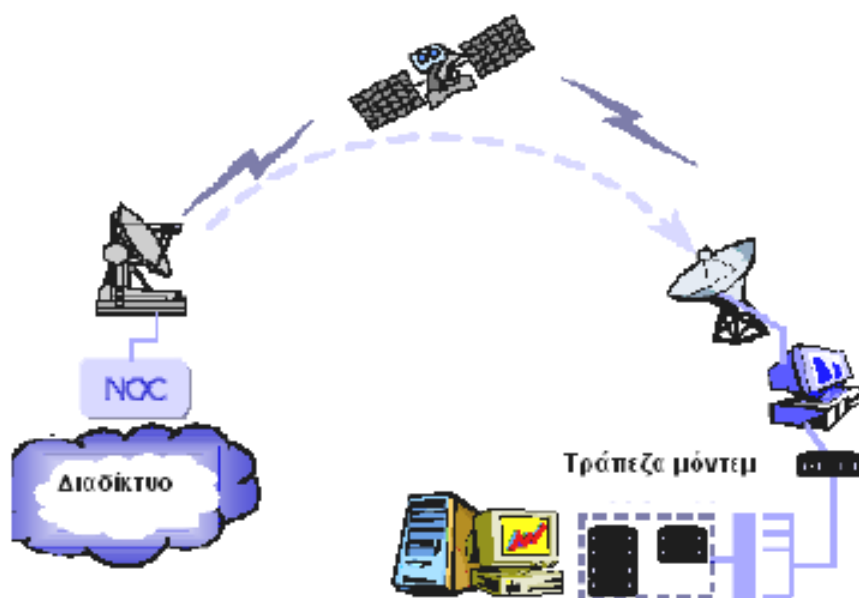
Σχήμα 6.3. Αρχιτεκτονική συστήματος διαδικτυακής επικοινωνίας με τη χρήση δορυφόρων
