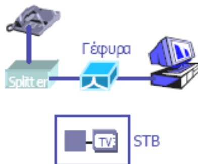
Σχήμα 4.12. Αρχιτεκτονική με χρήση Set-Top Box με ενσωματωμένο ADSL modem
