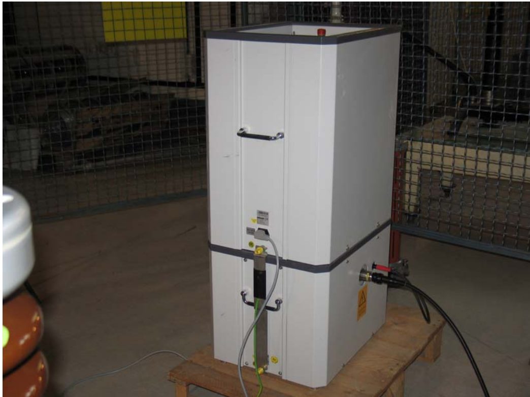
Εικόνα 6-8 : Η συσκευή VLF του Εργαστηρίου ΥΤ του Ε.Μ.Π. Διακρίνονται τα δύο μέρη της συσκευής : Operating Module (το πάνω μέρος) και HV module (το κάτω μέρος)
