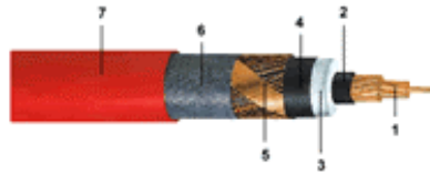
Σχ. 2-1 : 1) Πολύκλωνος στρογγυλός αγωγός χαλκού(ή αλουμινίου), 2) Εσωτερικό ημιαγωγίμο στρώμα XLPE, 3) Μόνωση XLPE, 4) Εξωτερικό ημιαγωγίμο στρώμα XLPE, 5) Ηλεκτρική θωράκιση αποτελούμενη από σύρματα χαλκού τυλιγμένα ελικοειδώς (χάλκινη ταινία προαιρετική κατόπιν παραγγελίας), 6) Πλαστική ταινία (προαιρετική), 7) Εξωτερικός μανδύας PVC
