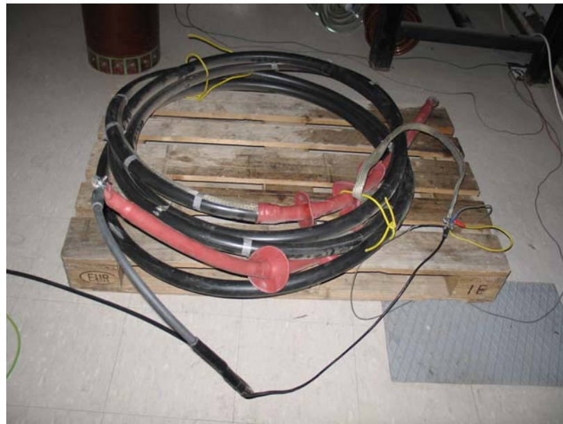
Εικόνα 6-12: Το καλώδιο συνδεδεμένο με τους ακροδέκτες της συσκευής VLF
