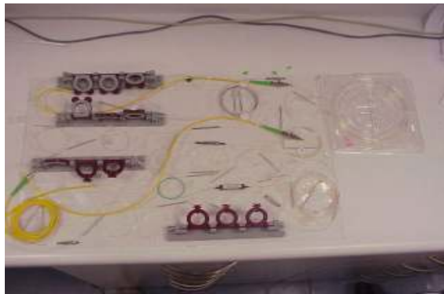
Σχήμα 3.22: Φωτογραφία της πειραματικής διάταξης του UNI ως 2×2 οπτικός διακόπτης μεταγωγής, όπως υλοποιήθηκε στο εργαστήριο.
