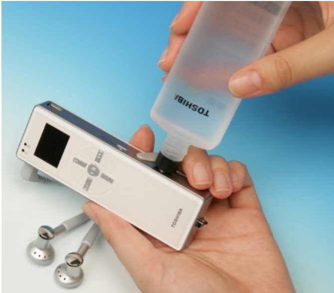
Εικόνα 3.4: MP3 Player και κινητό της Toshiba, με κυψέλη καυσίμου άμεσου μεθανόλης
