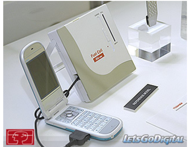
Εικόνα 3.4: MP3 Player και κινητό της Toshiba, με κυψέλη καυσίμου άμεσου μεθανόλης
