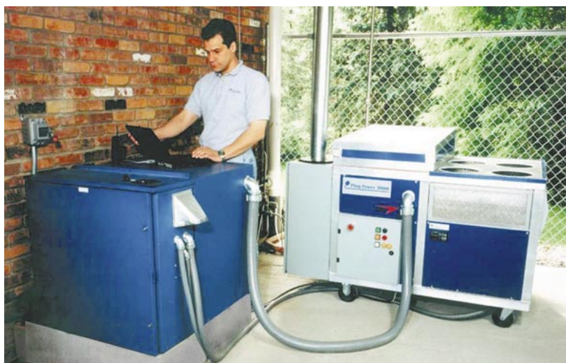
Εικόνα 3.3: Η πρώτη PEMFC ισχύος 7kW της Plug Power
