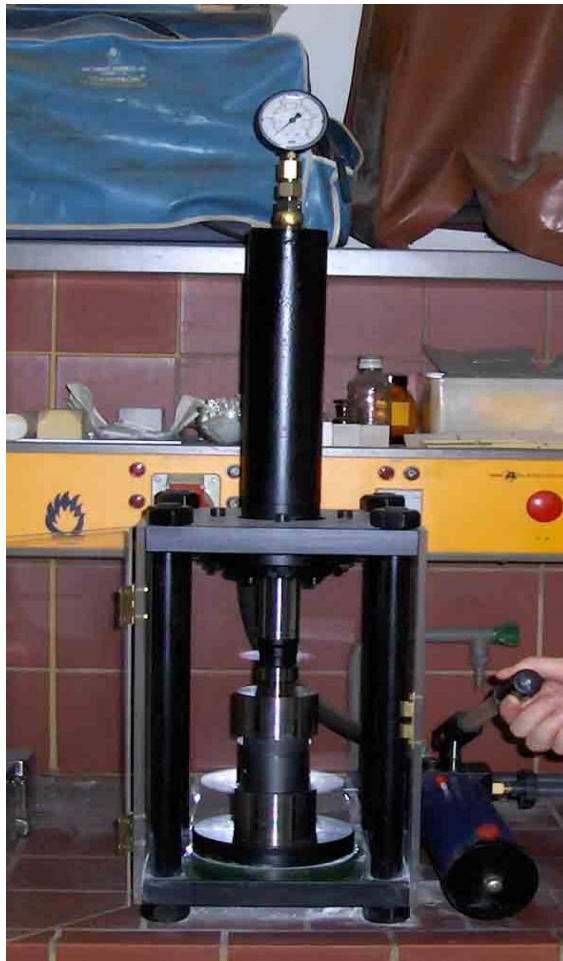
Σχήμα 5.1: Υδραυλική πρέσα ελαίου
