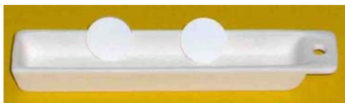
Σχήμα 5.11: Πυρίμαχο σκαφίδι και δισκία προς θερμική κατεργασία
