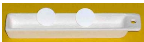
Σχήμα Π.1: Πυρίμαχο σκαφίδι και δισκία προς θερμική κατεργασία
