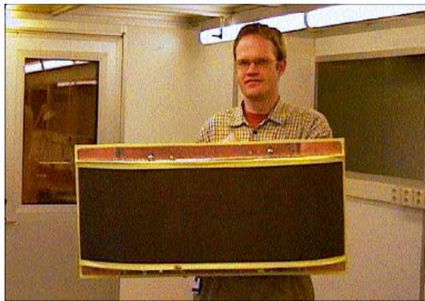
Σχήμα 3.29: Φυσικό μέγεθος έξυπνης κεραίας οκτώ στοιχείων με συχνότητα λειτουργίας στο 1.8GHz.
