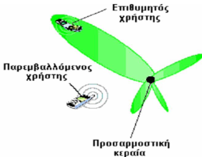
Σχήμα 3.19: Λειτουργία κεραίας adaptive array όταν υπάρχει και παρεμβάλλον χρήστης.
