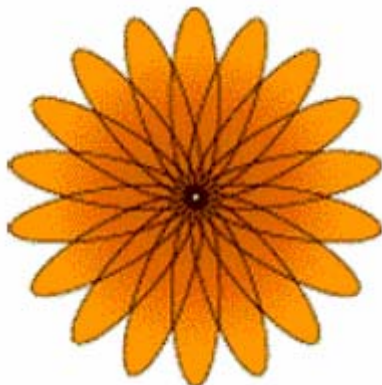
Σχήμα 3.13: Διάγραμμα ακτινοβολίας κεραιάς switched beams.
