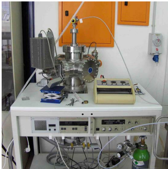
Εικόνα 2.8: Τετραπολικός Φασματογράφος Μαζών
