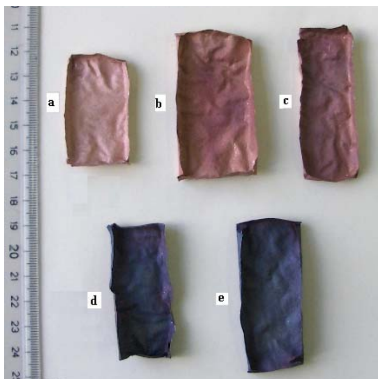
Εικόνα 2.6: Χρωματικές διαφοροποιήσεις δοκιμίων Χαλκού. (a) Δείγμα αναφοράς και δείγματα θερμοασμένα σε θερμοκρασία (b) 300°C, (c) 330°C, (d) 355°C, (e) 385°C.
