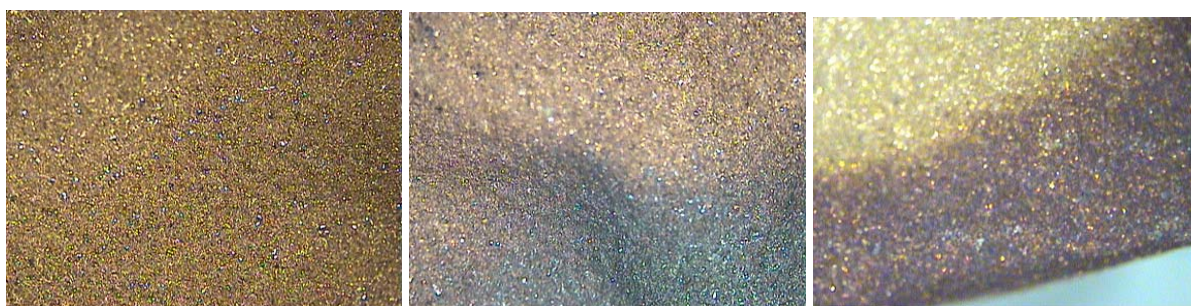
Εικόνα 2.8: Φωτογραφίες οπτικού μικροσκοπίου (μεγέθυνση x25). Στην αριστερή φωτογραφία εικονίζεται δείγμα αναφοράς, ενώ στην μεσαία και στην δεξιά εικονίζονται επιφάνειες από μερικώς προσβεβλημένα δοκίμια. Διακρίνεται ο διαφορετικός βαθμός προσβολής στις περιοχές της επιφάνειας.
