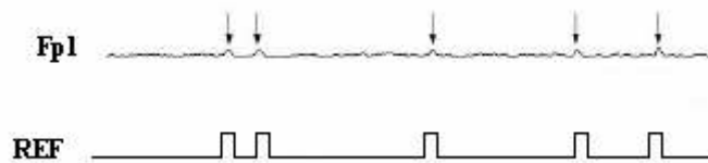
Σχήμα 4. 17: Παλμοσειρά-αναφορά του αλγόριθμου cICA για την απομάκρυνση του τεχνικού σφάλματος του ανοίγματος/κλεισίματος των βλεφάρων
