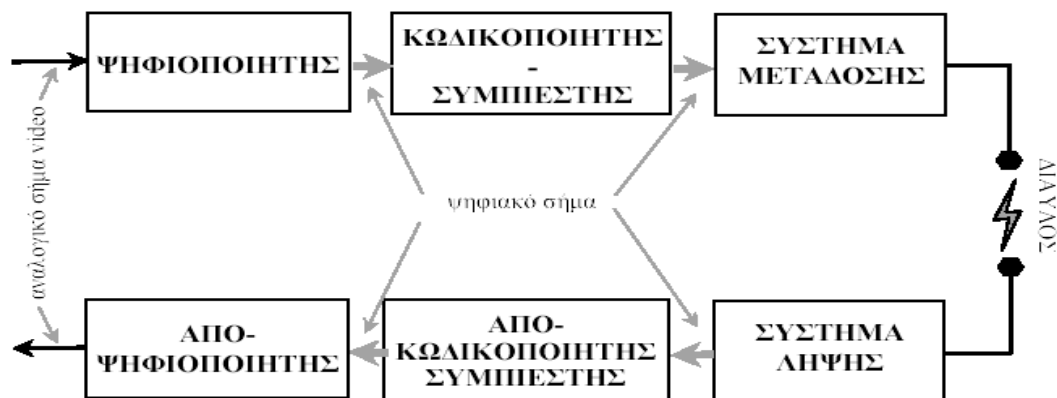
Σχήμα 1.14 Διαδικασία μετατροπής του αναλογικού σήματος της τηλεόρασης σε ψηφιακό
