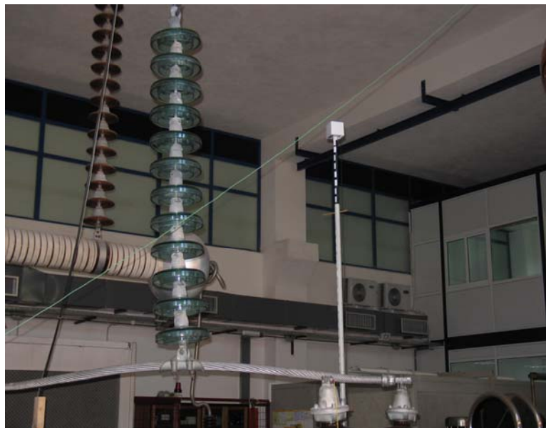
Εικόνα 5.5: Καθαρός γυάλινος αλυσοειδής μονωτήρας, τύπου ομίχλης, αποτελούμενος από δώδεκα (12) δισκοειδείς μονωτήρες
