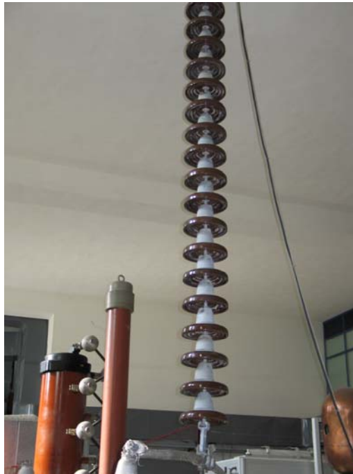
Εικόνα 5.7: Καθαρός πορσελάνινος αλυσοειδής μονωτήρας, τύπου κανονικού, αποτελούμενος από δεκαοκτώ (18) δισκοειδείς μονωτήρες.
