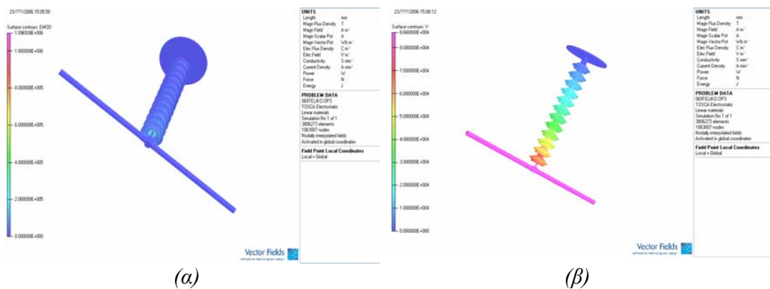
Σχήμα 4.6: Κατανομή (α) της έντασης του πεδίου και (β) του δυναμικού στην επιφάνεια του αλυσοειδούς μονωτήρα.
