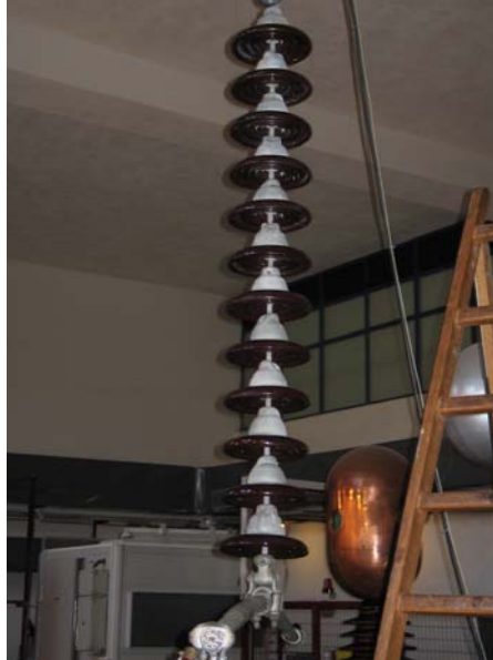
Εικόνα 5.6: Καθαρός πορσελάνινος αλυσοειδής μονωτήρας, τύπου κανονικού, αποτελούμενος από δώδεκα (12) δισκοειδείς μονωτήρες.
