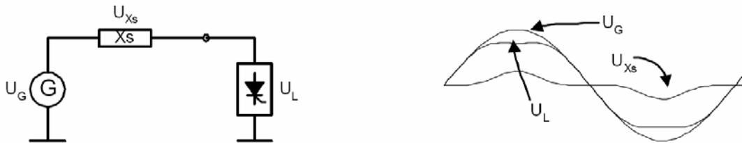
Σχήμα 2.40. : Ισοδύναμο κύκλωμα συστήματος με μη-γραμμικό φορτίο [9]
