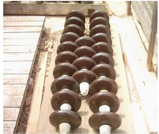
Σχήμα 1.17 Πορσελάνινοι μονωτήρες κανονικού τύπου.
