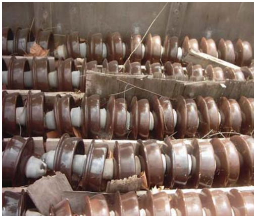
Σχήμα 1.16 Πορσελάνινοι μονωτήρες τύπου ομίχλης 150 kV.
