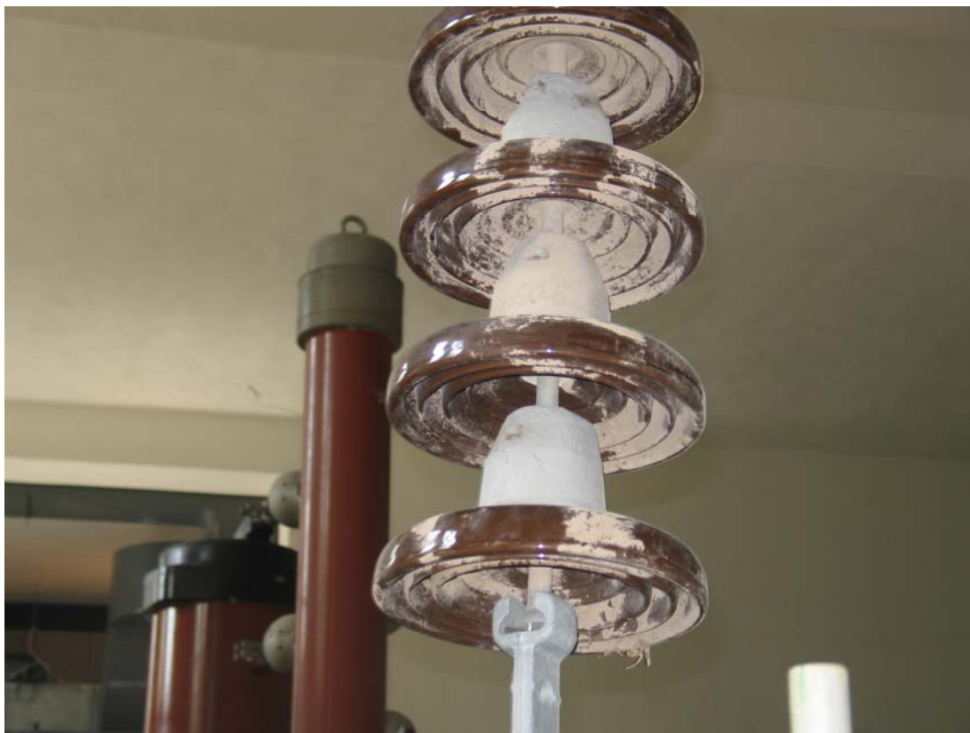
Σχήμα 3.1: Πορσελάνινος δισκοειδής μονωτήρας, τύπου κανονικού
