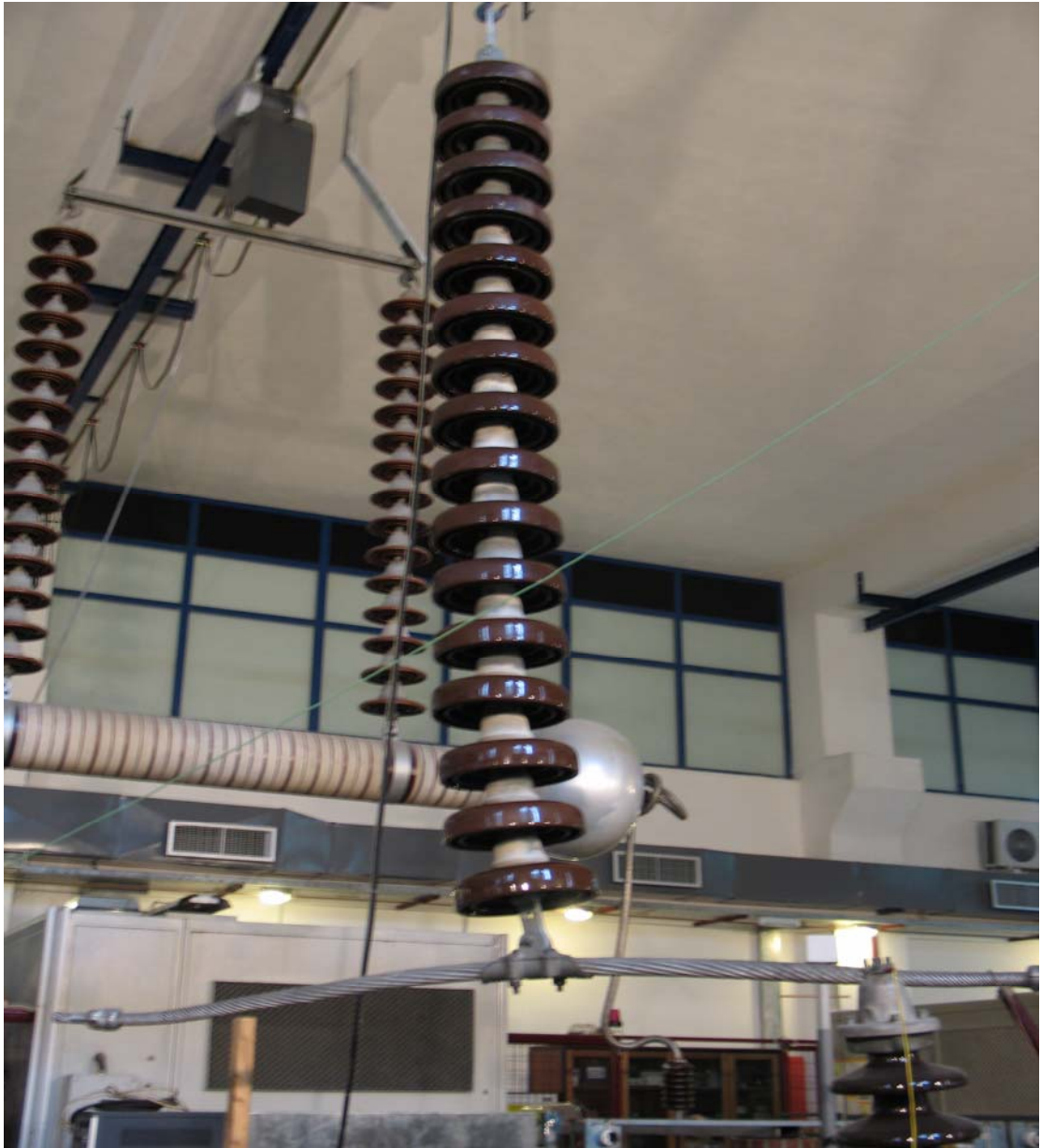
Σχήμα 4.64: Καθαρός πορσελάνινος αλυσοειδής μονωτήρας(100), τύπου ομίγλης, αποτελούμενος από δεκαέξι (16) δισκοειδείς μονωτήρες,
