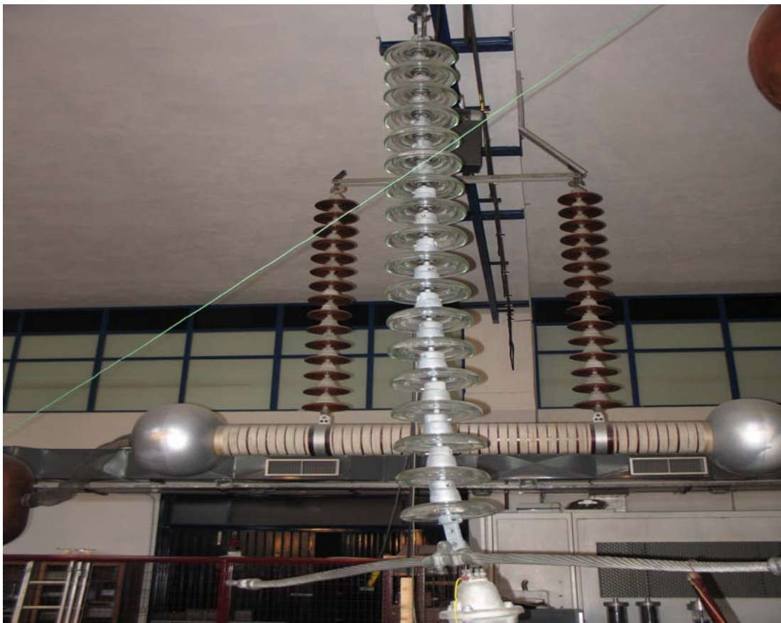
Σχήμα 4.26: Γυάλινος ρυπασμένος αλυσοειδής μονωτήρας (082), κανονικού τύπου 400 kV αποτελούμενος από δεκαοκτώ (18) δισκοειδείς μονωτήρες
