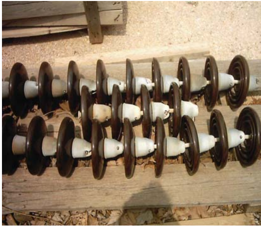
Σχήμα 1.17 Πορσελάνινοι μονωτήρες κανονικού τύπου.
