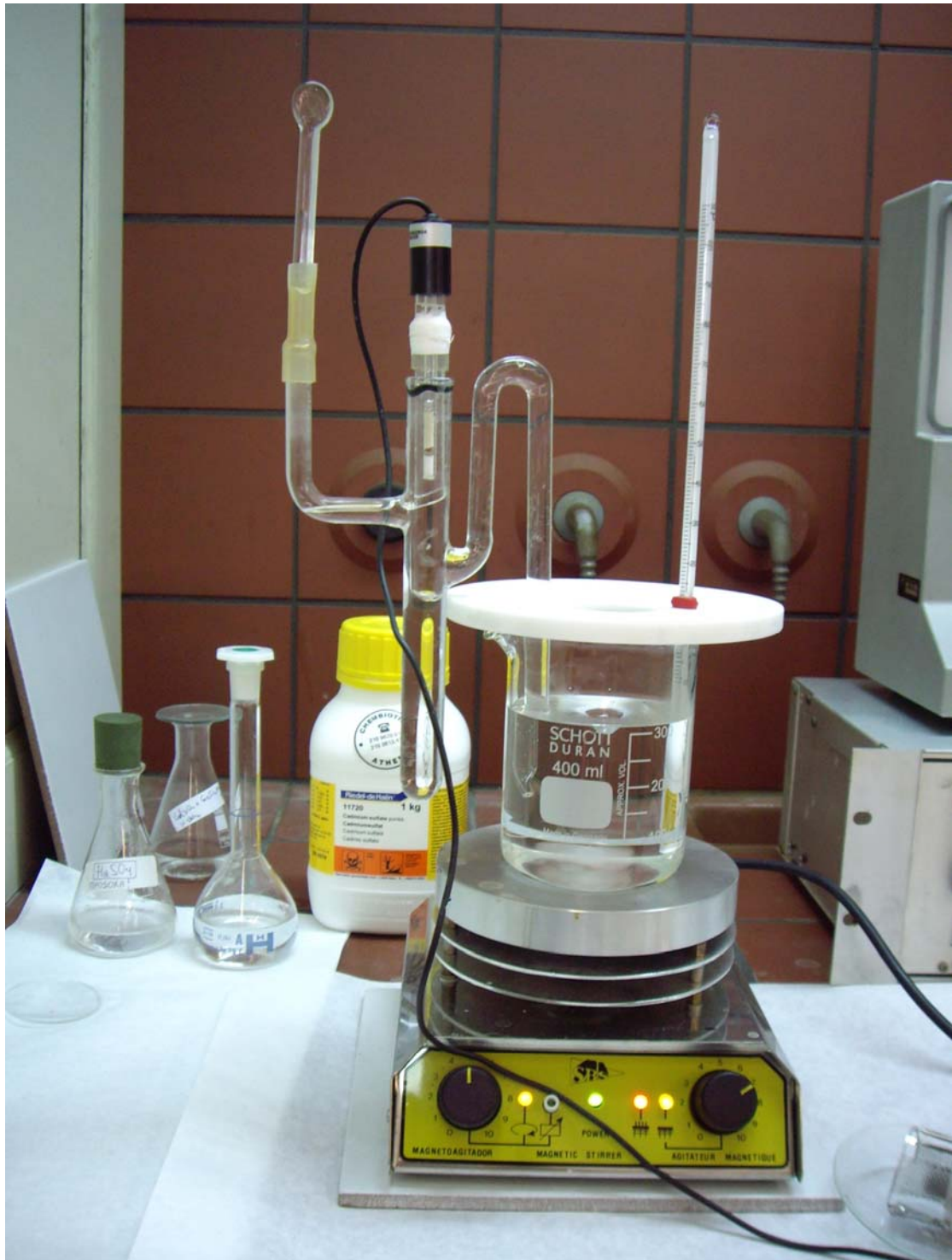
Σχήμα 5.2.1.1: Ηλεκτροχημική κυψελίδα και ηλεκτρικός θερμαστής της διάταξης.
