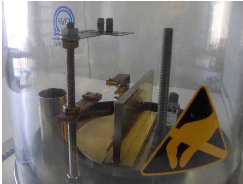
Σχήμα 5.8.2: Μετατροπή του νήματος χρυσού από στερεή σε αέρια κατάσταση.
