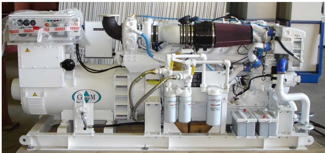
Σχήμα 44 : Ο ηλεκτρομηχανή Series S60 συνδεδεμένη με την γεννήτρια HCM 4
