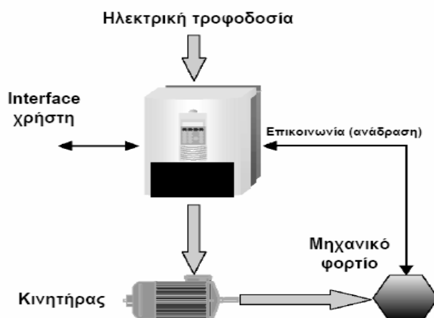
Σχήμα 2.3 – Βασικές συνιστώσες συστήματος ηλεκτρικής κίνησης
