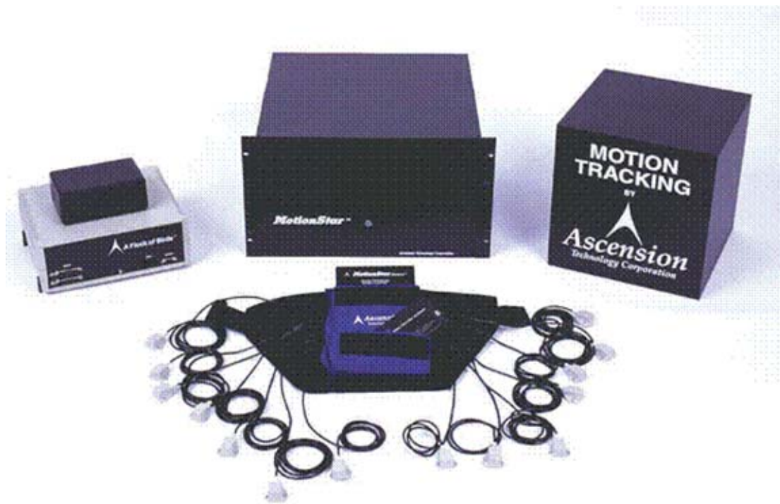
Εικόνα 15: Το σύστημα μαγνητικού εντοπισμού DC MotionStar, ένα σύστημα ακριβείας που χρησιμοποιείται για τη σύλληψη κίνησης για εφαρμογές computer animation, εντοπίζει τη θέση και τον προσανατολισμό έως 108 αισθητήρων σε ένα αντικείμενο ή σκηνή. Τα μέρη τους συστήματος είναι οι κεραίες εκπομπής μαγνητικών παλμών (δεξιά κι αριστερά) και οι κεραίες λήψης και ο ελεγκτής (κέντρο) (ΠΗΓΗ [13]).
