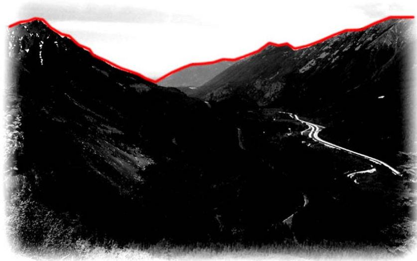
Εικόνα 8: Οριζόντιες μορφές εξηγμένες από μια οπτική σκηνή μπορούν να χρησιμοποιηθούν στατικά για να εντοπιστεί η θέση που παρατηρητή από ένα προκαθορισμένο σύστημα δεδομένων ή δυναμικά για να υπολογιστεί η κίνηση της κάμερας προσαρτημένης σε όχημα.
