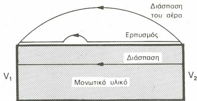
Σχήμα 1.16: Η απώλεια της μονωτικής δράσης ενός στερεού μονωτικού μπορεί να γίνει με ηλεκτρική διάσπαση του υλικού ή με υπερπήδηση που εκδηλώνεται με ρεύμα ερπυσμού και με διάσπαση στον αέρα [6].
