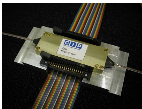
Σχήμα 3.8: Φωτογραφία του ολοκληρωμένου εμπορικά διαθέσιμου τετραπλού HMZI διακόπτη. Οι διαστάσεις είναι περίπου 90\text{mm} (L) \times 31\text{mm} (W) \times 13\text{mm} (D).
