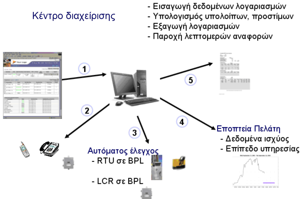
Σχήμα 8.17 Δομή κέντρου διαχείρισης και ελέγχου δικτύου BPL
