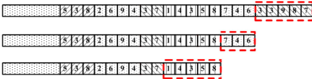
Σχήμα 3.4: Παράδειγμα εφαρμογής επάλληλου παραθύρου πάνω σε ρεύμα δεδομένων.
