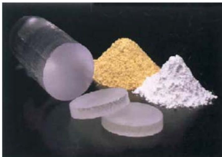
Εικόνα 31. Κύλινδρος ενός κρυστάλλου LSO και ακατέργαστο λουτέτιο (καφέ) και καθαρό υλικό (άσπρο).
