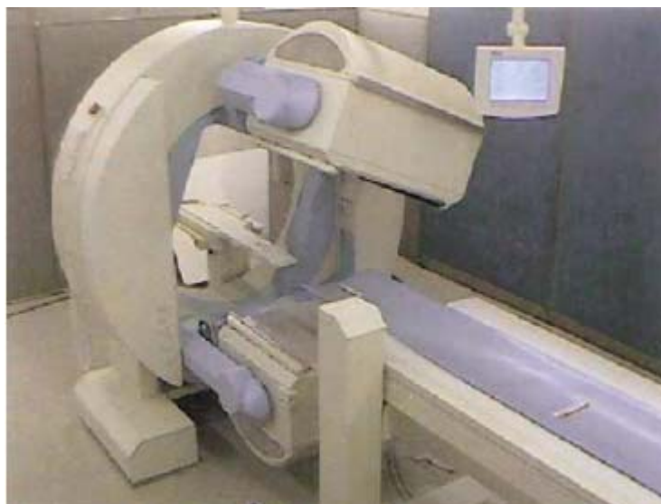
Εικόνα 34. Ένας συνδυασμός LSO και NaI(Tl) τομογράφου για PET και SPECT.
