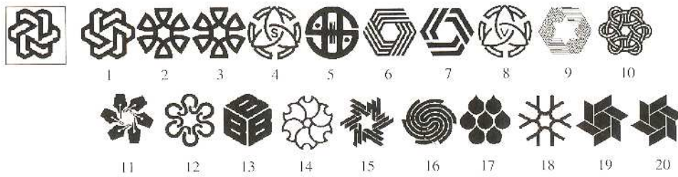
Σχήμα 2.12: Παράδειγμα ανάκτησης ομοιότητας για τον περιγραφέα σχήματος με βάση το σχήμα στην βάση δεδομένων με εμπορικά σχήματα
