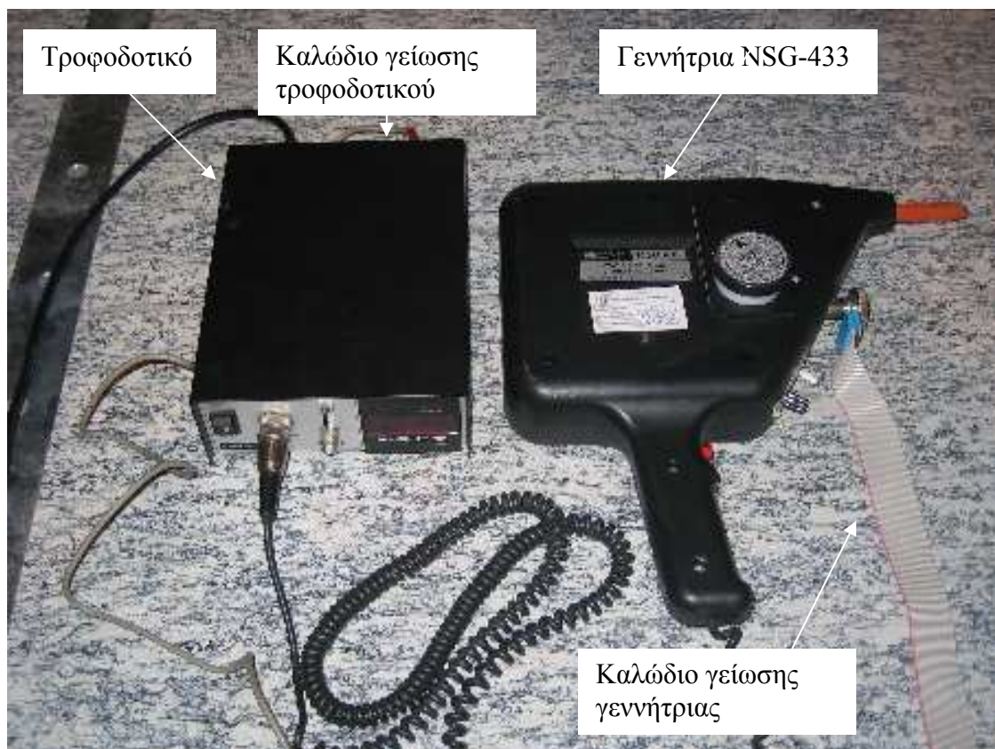
Σχήμα 4.3: Η γεννήτρια NSG-433
