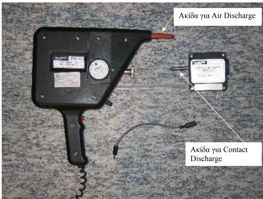
Σχήμα 4.4: Ακίδες για εκκενώσεις μέσω αέρα και επαφής για την γεννήτρια NSG-433
