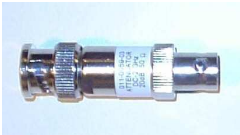
Σχήμα 4.9: Ο εξασθενητής (attenuator) 011-0059-03
