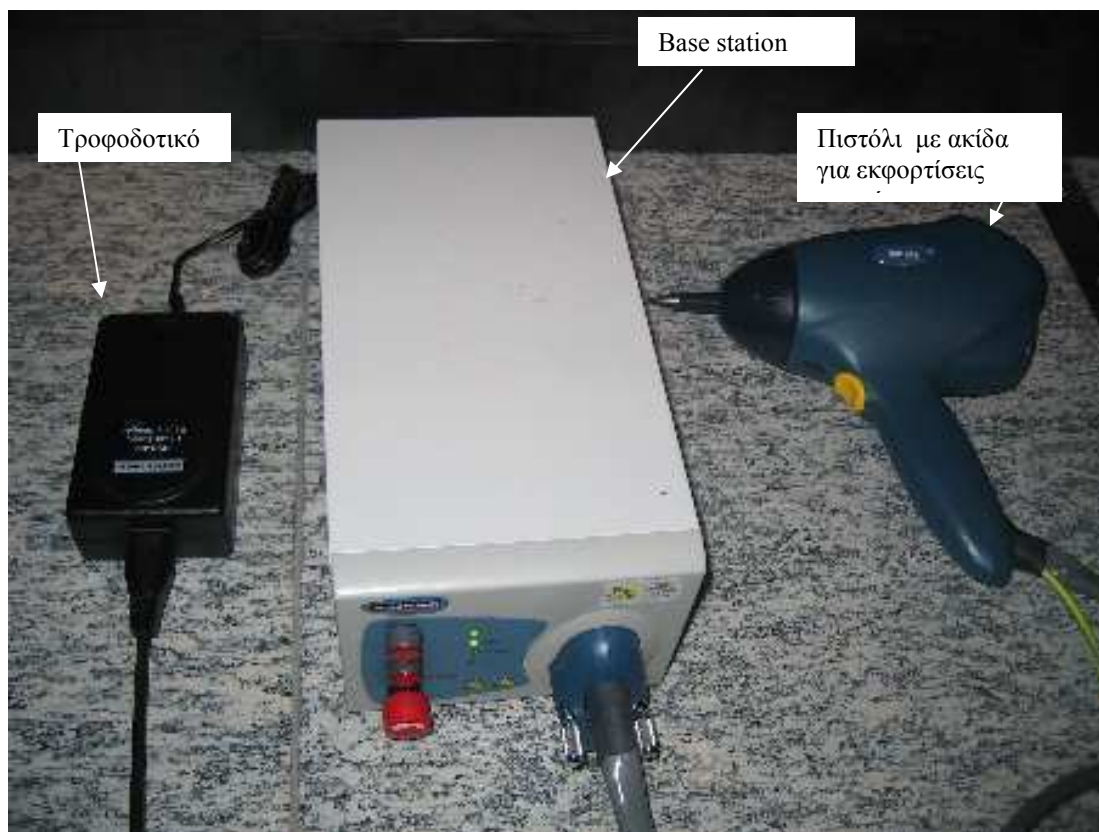
Σχήμα 4.5: Τα βασικά τμήματα της γεννήτριας NSG-438
