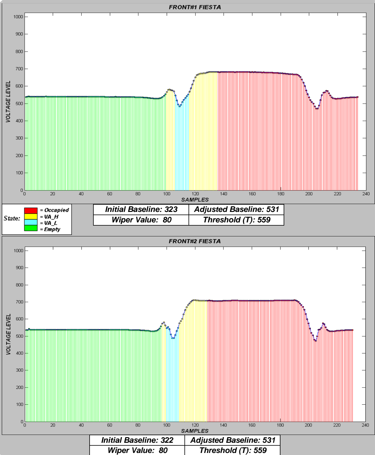
ΣΧΗΜΑ 6.15 – ΔΙΑΓΡΑΜΜΑΤΑ ΠΕΙΡΑΜΑΤΙΚΩΝ ΜΕΤΡΗΣΕΩΝ ΑΠΟ ΤΗ ΣΤΑΘΜΕΥΣΗ ΚΑΙ ΤΗΝ ΑΜΕΣΗ ΑΝΑΧΩΡΗΣΗ ΤΟΥ ΟΧΗΜΑΤΟΣ FORD FIESTA. ΠΡΟΣΘΙΟ ΜΕΡΟΣ (ΔΥΟ ΔΟΚΙΜΕΣ)
