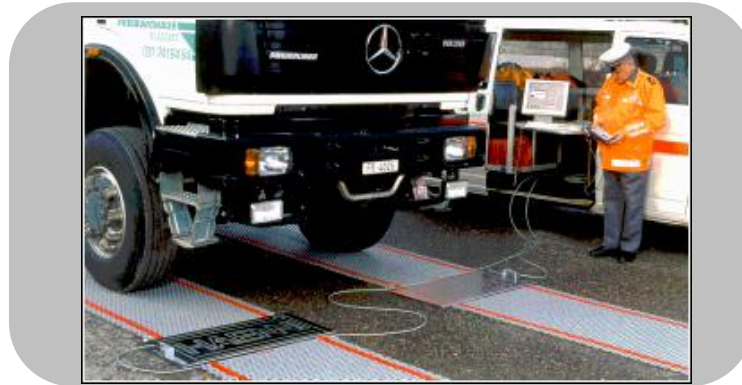
ΣΧΗΜΑ 2.16 - ΕΦΑΡΜΟΓΗ ΤΗΣ ΤΕΧΝΟΛΟΓΙΑΣ ΣΤΡΩΜΑΤΟΣ ΧΩΡΗΤΙΚΟΤΗΤΑΣ [5]
