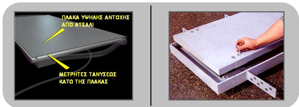
ΣΧΗΜΑ 2.13 - ΑΠΑΡΤΙΖΟΜΕΝΑ ΜΕΡΗ ΚΑΙ ΕΦΑΡΜΟΓΗ ΤΗΣ ΤΕΧΝΟΛΟΓΙΑΣ ΚΕΚΛΙΜΕΝΗΣ ΠΛΑΚΑΣ [ 6,7 ]
