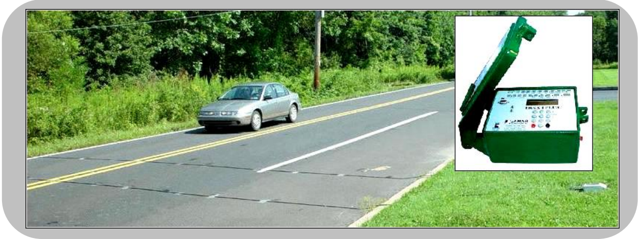
ΣΧΗΜΑ 2.7 - ΕΓΚΑΤΑΣΤΑΣΗ ΠΝΕΥΜΑΤΙΚΟΥ ΣΩΛΗΝΑ ΚΑΙ ΜΕΤΡΗΤΗΣ [ V ]
