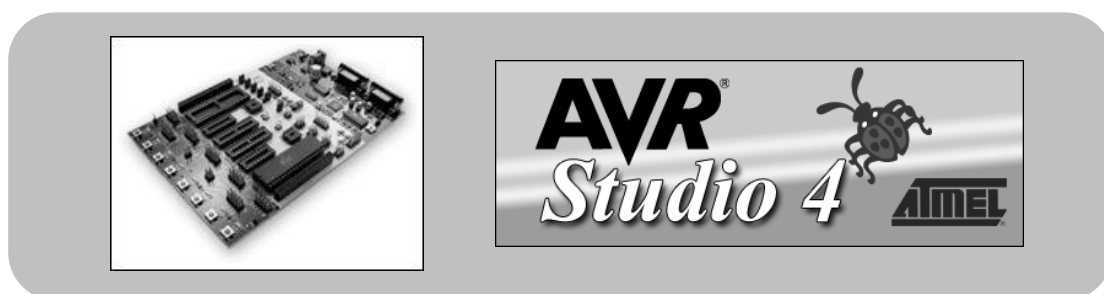
ΣΧΗΜΑ 5.12 - ΣΥΣΤΗΜΑ ΚΑΙ ΠΕΡΙΒΑΛΛΟΝ ΑΝΑΠΤΥΞΗΣ STK500 ΚΑΙ AVR STUDIO 4 ΤΗΣ ATMEL[v]
