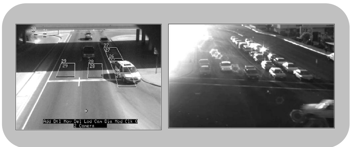
ΣΧΗΜΑ 2.29 - ΔΥΣΛΕΙΤΟΥΡΓΙΑ ΤΕΧΝΟΛΟΓΙΑΣ VIP ΛΟΓΩ ΣΚΙΑΣΕΩΝ Ή ΕΝΤΟΝΟΥ ΦΩΤΙΣΜΟΥ[ 4 ]
