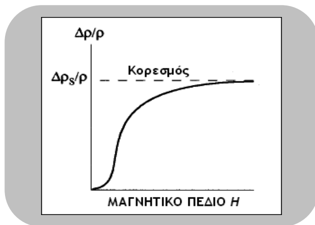
ΣΧΗΜΑ 3.16 - ΣΧΕΔΙΑΓΡΑΜΜΑ ΤΗΣ ΜΕΤΑΒΟΛΗΣ ΤΗΣ ΕΙΔΙΚΗΣ ΑΝΤΙΣΤΑΣΗΣ ΜΕ ΤΗΝ ΕΝΤΑΣΗ ΤΟΥ ΕΠΙΒΑΛΛΟΜΕΝΟΥ ΜΑΓΝΗΤΙΚΟΥ ΠΕΔΙΟΥ [ 15 ]
