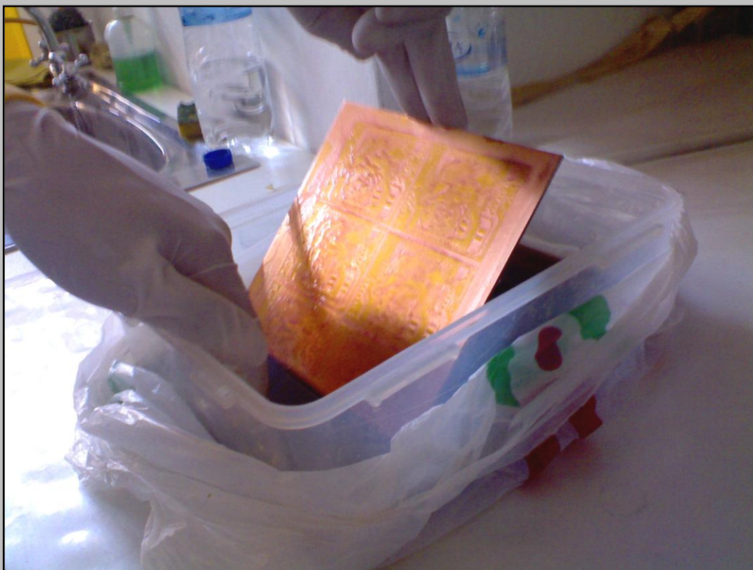
ΣΧΗΜΑ 6.7 – ΣΤΑΔΙΟ ΕΜΒΑΠΤΙΣΗΣ ΤΗΣ ΠΛΑΚΕΤΑΣ ΣΕ ΕΙΔΙΚΟ ΔΙΑΛΥΜΑ ΟΞΕΟΣ, ΓΙΑ ΑΠΟΜΑΚΡΥΝΣΗ ΜΗ ΕΠΙΘΥΜΗΤΩΝ ΕΠΙΦΑΝΕΙΩΝ ΧΑΛΚΟΥ.
