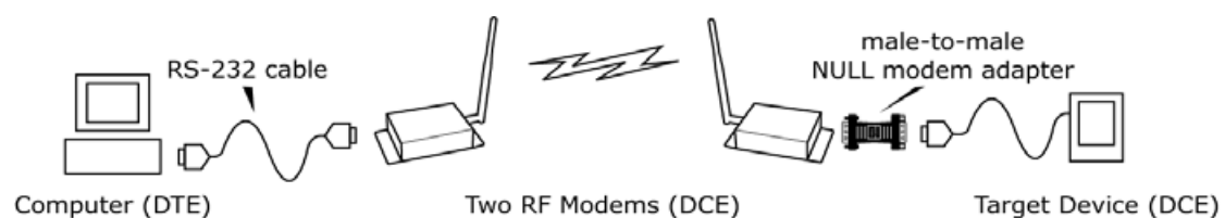
Εικόνα 4: Διασύνδεση υπολογιστή με εξωτερική συσκευή σειριακής επικοινωνίας
