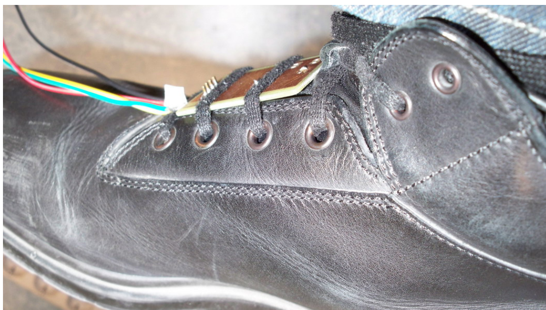
Σχήμα 9-5: Το υποσύστημα επιταχυνσιομέτρου τοποθετημένο στο πόδι.
