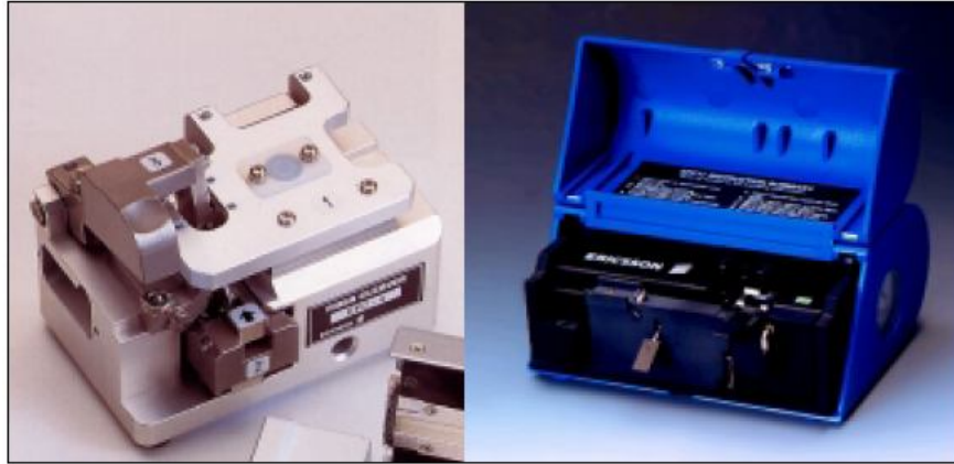
Εικόνα 13. Η ποιότητα του κόφτη που χρησιμοποιείται μπορεί συχνά να προσδιορίσει την ποιότητα μιας κόλλησης. Ένας κόφτης οπτικών ινών καλής ποιότητας, κόβει την οπτική ίνα υπό γωνία 90° χωρίς να δημιουργεί μικρο-ατέλειες. Οι παραπάνω κόφτες κατασκευάζονται από τις εταιρίες Sumitomo (αριστερά) και Ericsson (δεξιά). Ο πρώτος κόφτης χρησιμοποιείται και για κοπή κορδελών ινών
