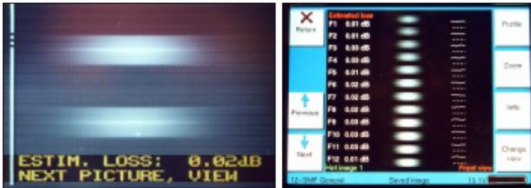
Εικόνα 15. Δυο εικόνες ηλεκτρονικής σάρωσης. Η εικόνα στα αριστερά έχει ληφθεί κατά τη διάρκεια της fusion κόλλησης μιας ίνας, ενώ η εικόνα στα δεξιά έχει ληφθεί κατά την αντίστοιχη διαδικασία για μια κορδέλα 12 ινών. Ο πυρήνας παρουσιάζεται ως μια φωτεινή περιοχή στο μέσο της ίνας.
