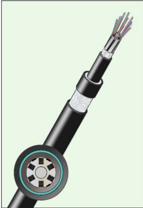
Εικόνα 24. Οπτικό καλώδιο με θερμο-διαστελλόμενη ταινία. Το καλώδιο που εικονίζεται περιέχει 192 οπτικές ίνες και έχει κωδική ονομασία GASLLDV
