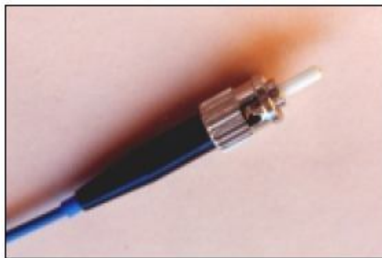
Εικόνα 29. ST connector με bayonet μέλος και κεραμικό συνεκτικό δακτύλιο
