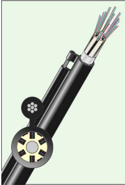
Εικόνα 26. Οπτικό καλώδιο με ενίσχυση διαστελλόμενου εξωτερικού σκέλους. Η κωδική ονομασία του είναι GASLCV
