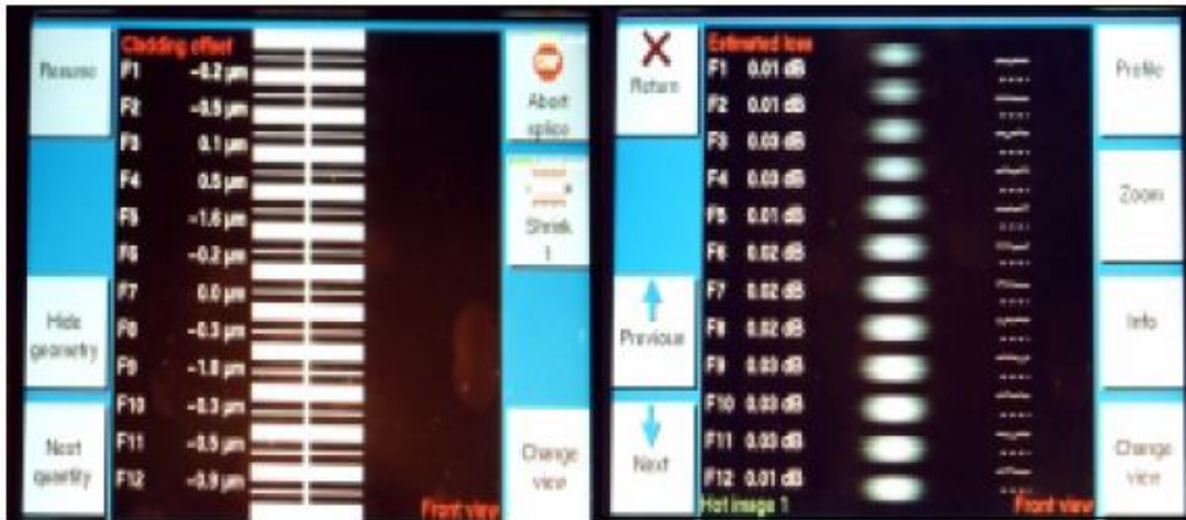
Εικόνα 11. Φωτογραφίες που έχουν ληφθεί πριν και μετά την κόλληση μιας κορδέλας 12 ινών. Στη δεύτερη φωτογραφία φαίνονται οι μετρήσεις των απωλειών κολλήσεων. Για την κόλληση χρησιμοποιήθηκε το Fusion splicer RSU12
