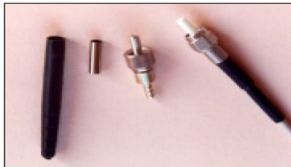
Εικόνα 24. Ο SMA connector αποτελεί διεθνές standard. Η εικόνα παρουσιάζει δυο connector, ο ένας έχει κεραμικό ενώ ο άλλος μεταλλικό συνεκτικό δακτύλιο
