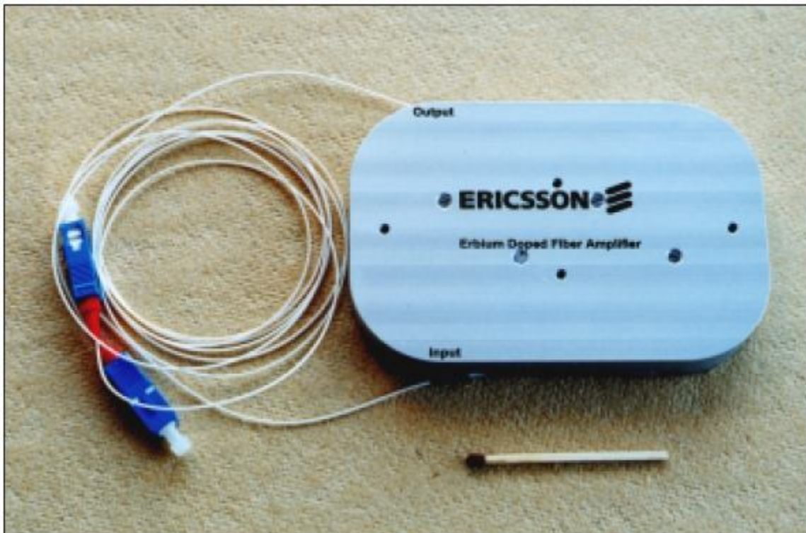
Εικόνα 7. EDFA κατασκευασμένος από την Ericsson, με μέγεθος που μπορεί να συγκριθεί με ένα σπύρτο
