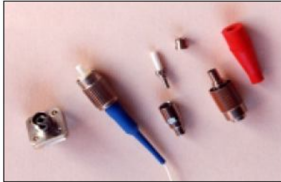
Εικόνα 25. Διάφορα μέρη ενός FC connector
