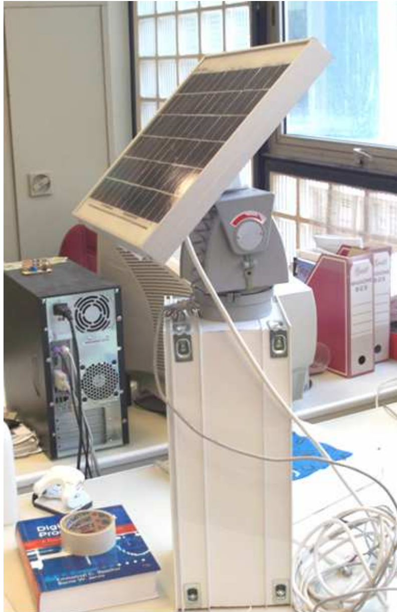
Σχήμα 6.6. Η ολοκληρωμένη κατασκευή του solar tracker
