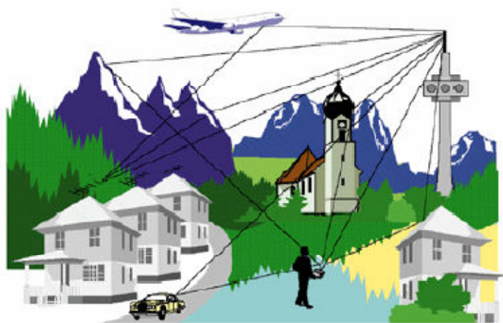
Σχήμα 1.19: Λήψη DVB-T με πολυδιαδρομική διάδοση (Multipath reception)
