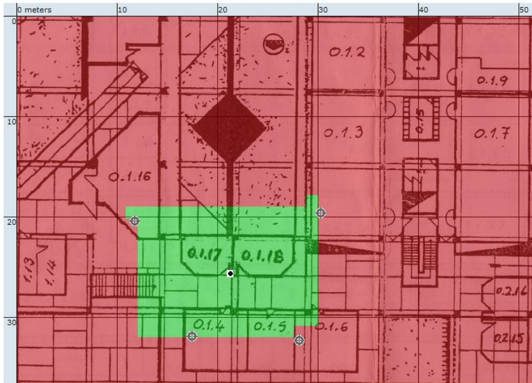
Σχήμα 5.6 Απεικόνιση της περιοχής με την αναμενόμενη ακρίβεια εντοπισμού (πράσινη περιοχή) από το εργαλείο Inspect Location Readiness
