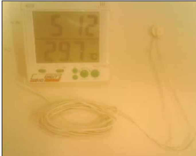
Εικόνα 8. Πρότυπο ηλεκτρονικό θερμόμετρο που χρησιμοποιήθηκε ως αναφορά
