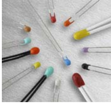
Εικόνα 3. Οικογένεια στοιχείων NTC θερμίστορ
