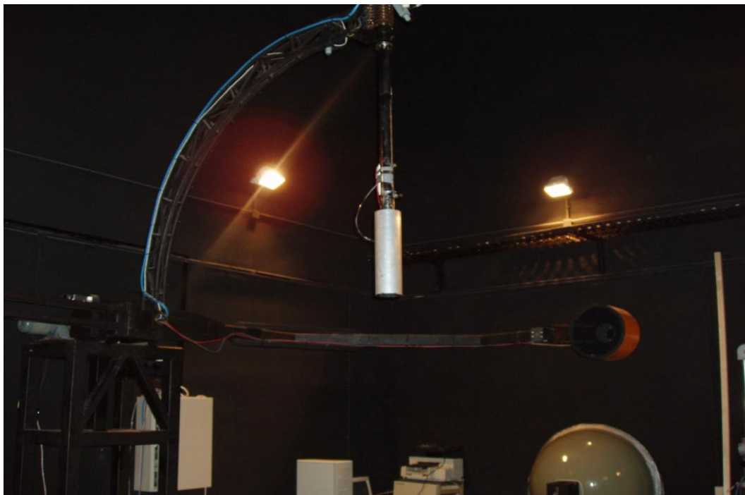
Σχήμα 3.10 : Φωτογραφία πειραματικής διάταξης. Διακρίνεται ο μεταλλικός σωλήνας αναρτημένος στον κάθετο άξονα περιστροφής. (Εργαστήριο Φωτοτεχνίας Ε.Μ.Π.)
