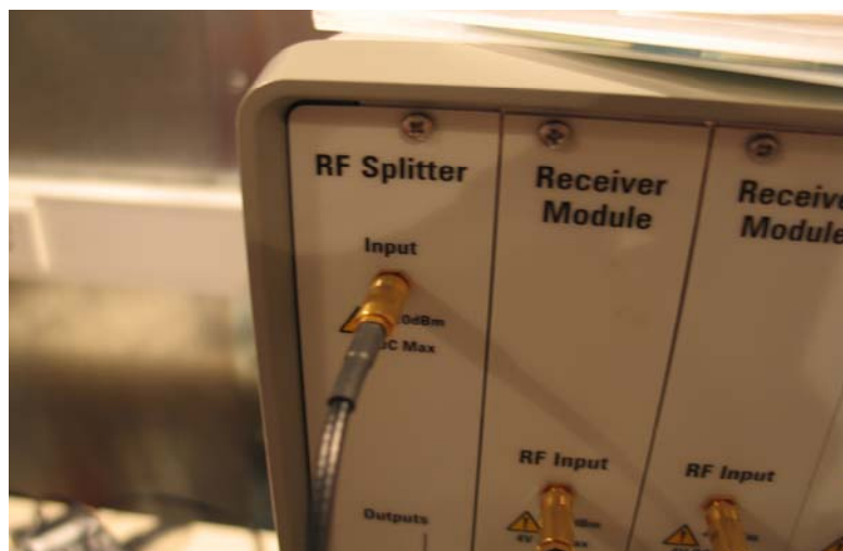
Φωτογραφία 6: Σύνδεση ομοαξονικού καλωδίου με τον αναλυτή διαταραχών.
