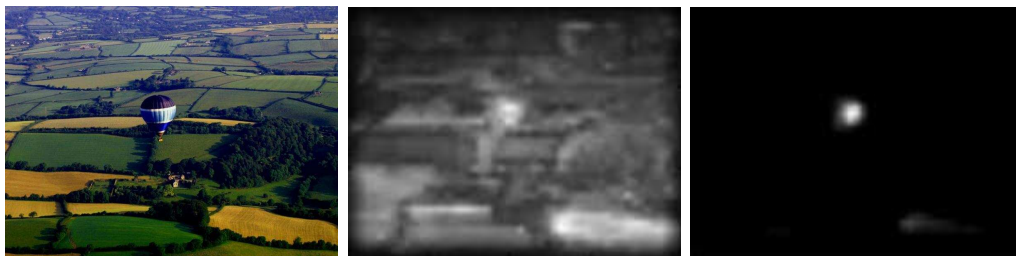
Σχήμα 3.25: Χάρτες οπτικής προσοχής της αρχικής εικόνας balloon (αριστερά) χρησιμοποιώντας άθροιση με τον τελεστή N (κέντρο) και επαναληπτική άθροιση (δεξιά). Τα αποτελέσματα λήφθηκαν με τη χρήση του Saliency Toolbox.
