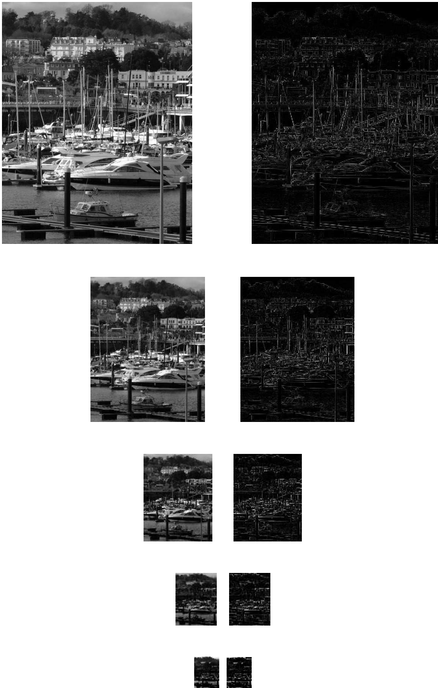
Σχήμα 2.12: Αριστερά: πυραμίδα κυματιδίων Haar (Haar wavelet), Δεξιά: αντίστοιχη “ Λαπλασιανή ” L^H , μαζί με τα πρώτα τέσσερα επίπεδα από πάνω προς τα κάτω, για την εικόνα harbor την αρχική μορφή της οποίας βλέπουμε στο επίπεδο 0 της πυραμίδας κυματιδίων (Haar) πάνω αριστερά. Η L^M πυραμίδα έχει κανονικοποιηθεί μεταξύ των ελάχιστων και μέγιστων τιμών κάθε επιπέδου ώστε να είναι πιο ευδιάκριτη.
