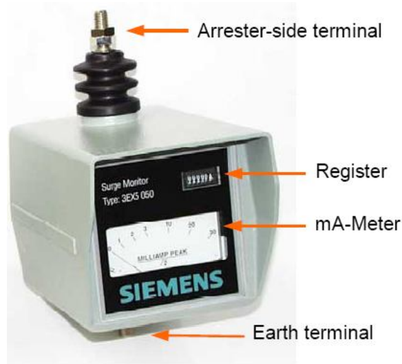
Σχήμα 2.11: Μετρητής ρεύματος διαρροής [8]
