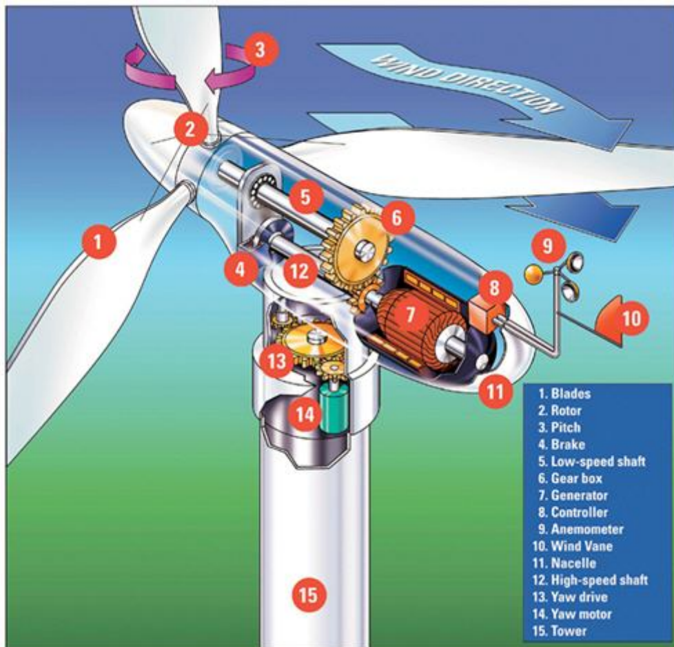
Σχήμα 8.4: Τα κατασκευαστικά μέρη μιας ανεμογεννήτριας
