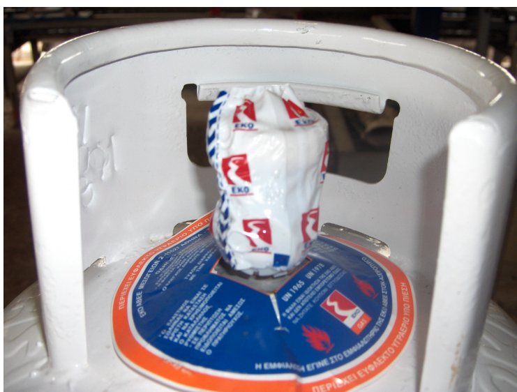
Σχήμα 4.14. Τοποθέτηση Διακριτικών Ταινιών
